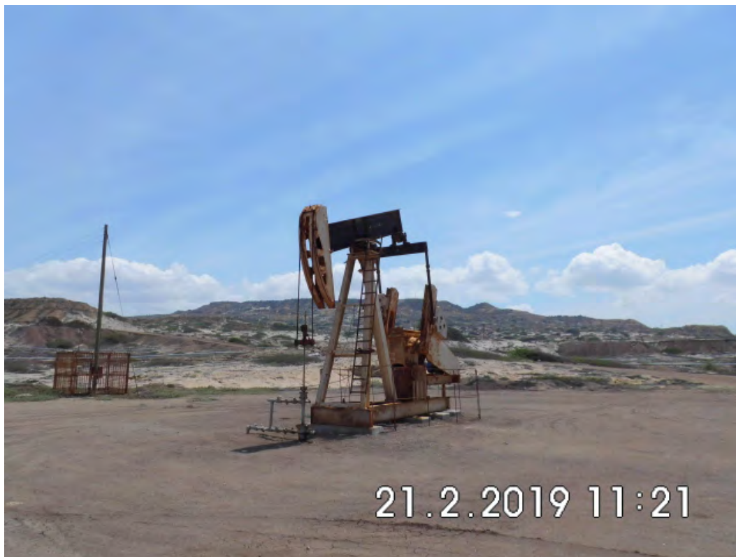
Fotografía 1. Pozo EA11131 (Coordenadas WGS84-zona 17S: 471395mE, 9523656mN), pozo productivo tipo BM. Vista desde cerca del pozo. Sin indicio de derrame de hidrocarburos ni alteración de suelo.
