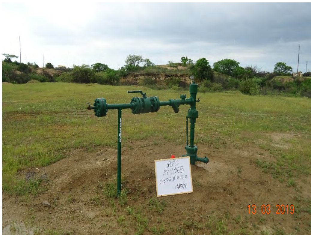
Fotografía 1. Pozo EA11368 (Coordenadas WGS84-zona 17S: 485257mE, 9530338mN), pozo productor tipo BM. Vista desde cerca del pozo. Sin indicio de derrame de hidrocarburos ni alteración de suelo.
