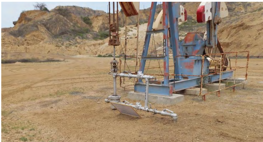
Fotografía 1. Pozo EA11011 (Coordenadas WGS84-zona 17S: 474642 mE, 9524965 mN), pozo productivo tipo BM. Vista desde cerca del cabezal del pozo. Sin indicio de derrame de hidrocarburos ni alteración de suelo.
