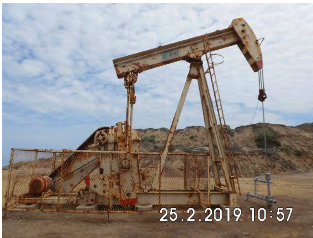
Fotografía 1. Pozo EA11032D (Coordenadas WGS84-zona 17S: 471683mE, 9524979mN), pozo productivo tipo BM. Vista desde cerca del pozo. Sin indicio de derrame de hidrocarburos ni alteración de suelo.
