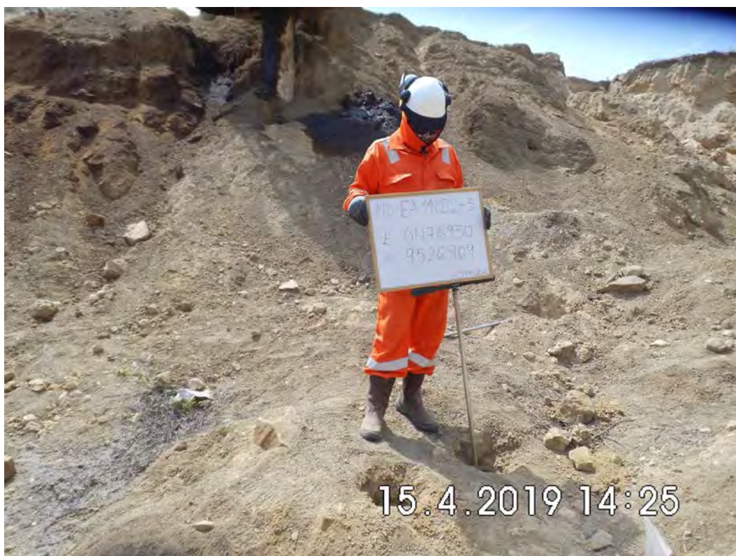
Fotografía 4. Pozo EA11022. Se realizó un muestreo a detalle en 3 puntos de muestreo. Muestreo en intervalos de 25 cm, profundidad máxima de 1.00 y 3.00 metros.
