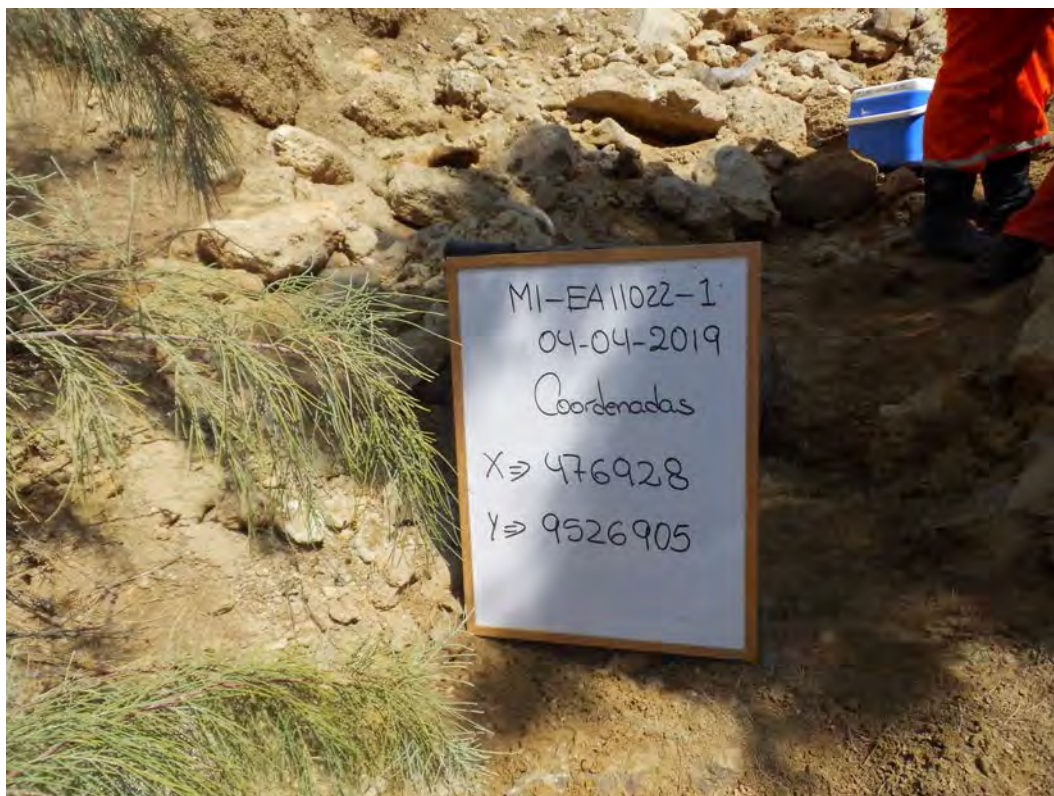
Fotografía 3. Pozo EA11022. Muestreo de Identificación. Muestreo en intervalos de 25 cm, profundidad máxima de 1.00 metro.
