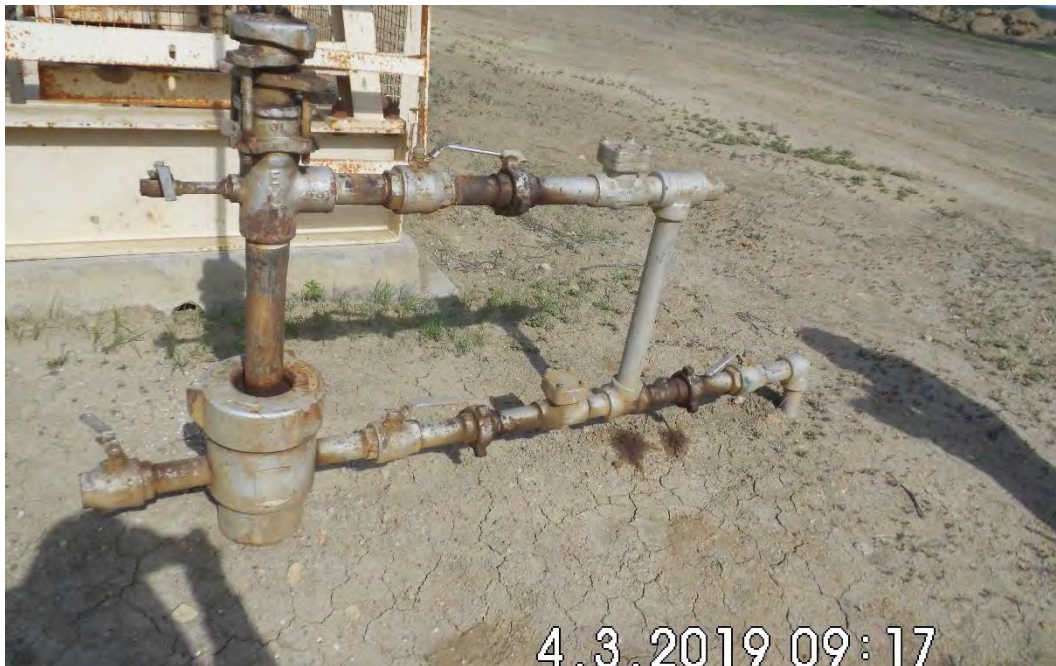
Fotografía 1. Pozo EA11304D (Coordenadas WGS84-zona 17S: 476845mE, 9530497mN), pozo productivo tipo BM. Vista desde cerca del pozo. Sin indicio de derrame de hidrocarburos ni alteración de suelo.
