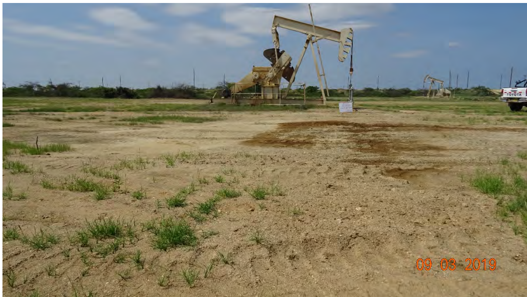
Fotografía 2. Pozo EA8561 la mancha del derrame de hidrocarburos y alteración de suelo alrededor de su ducto muy próximo al pozo.
