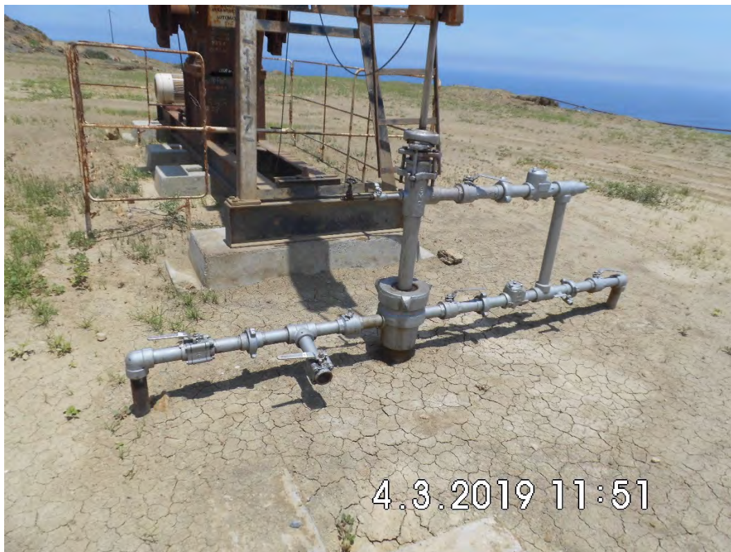
Fotografía 1. Pozo EA11117 (Coordenadas WGS84-zona 17S: 477094mE, 9531165mN), pozo productivo tipo BM. Vista desde cerca del pozo. Sin indicio de derrame de hidrocarburos ni alteración de suelo.
