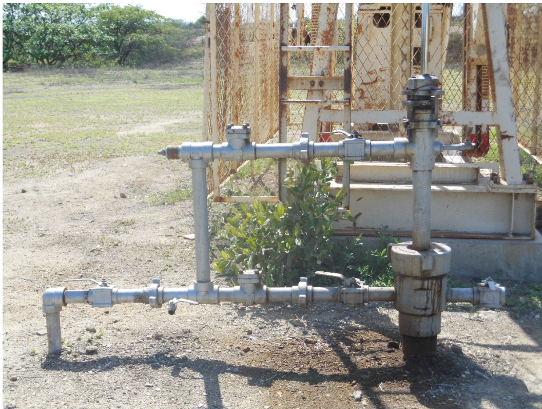
Fotografía 1. Pozo EA11259D (Coordenadas WGS84-zona 17S: 482403mE, 9528207mN), pozo productor tipo BM. Vista desde cerca del pozo. Con indicio de derrame de hidrocarburos y alteración de suelo alrededor del cabezal de pozo con un área de aproximadamente 1.5 m 2 .
