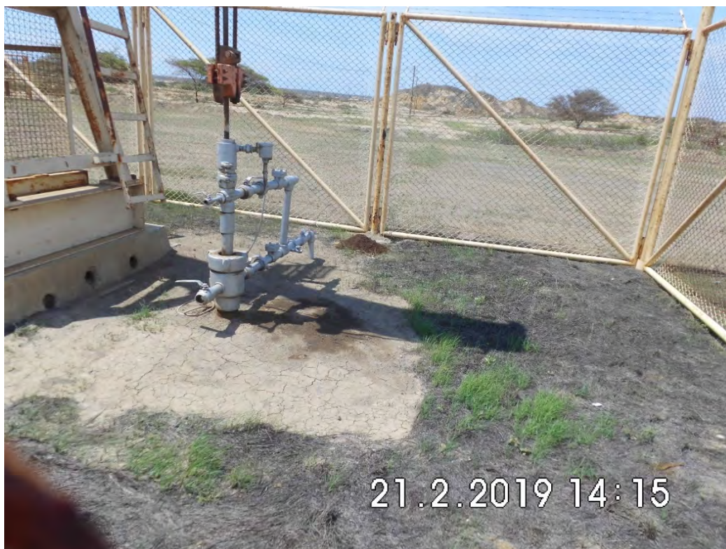
Fotografía 1. Pozo EA11336D (Coordenadas WGS84-zona 17S: 474815mE, 9525252mN), pozo productivo tipo BM. Vista desde cerca del pozo. Sin indicio de derrame de hidrocarburos ni alteración de suelo.
