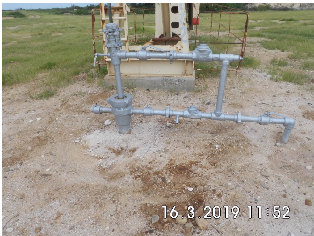
Fotografía 1. Pozo EA8172 (Coordenadas WGS84-zona 17S: 485724mE, 9529110mN), pozo productor tipo BM. Vista desde cerca del pozo. Con indicio de derrame de hidrocarburos y alteración de suelo alrededor del cabezal de pozo con un área de aproximadamente 1.5 m 2 .
