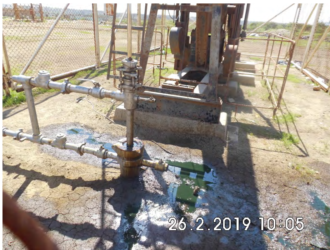
Fotografía 2. Pozo EA8609 la mancha del derrame de hidrocarburos y alteración de suelo alrededor de su ducto muy próximo al pozo.
