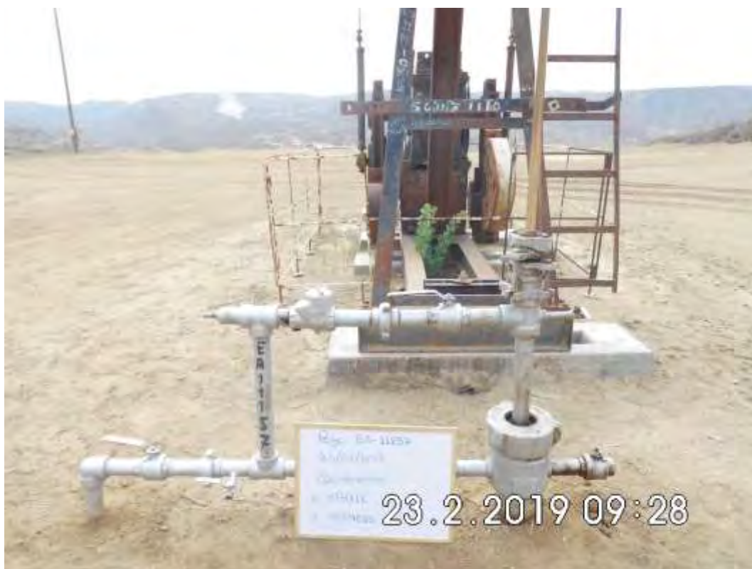
Fotografía 1. Pozo EA11157 (Coordenadas WGS84-zona 17S: 474212mE, 9524822mN), pozo productor tipo BM. Vista desde cerca del pozo. Sin indicio de derrame de hidrocarburos ni alteración de suelo.
