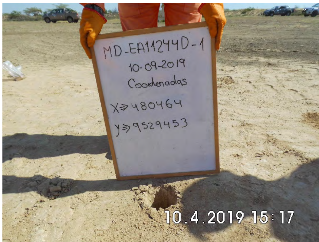
Fotografía 4. Muestreos de suelo a profundidades de 75-100 cm y 175-200 cm.
