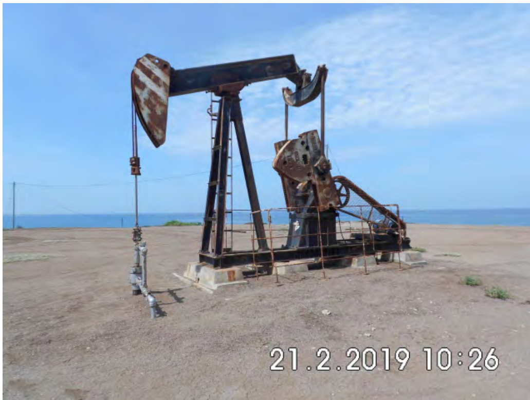
Fotografía 1. Pozo EA11269D (Coordenadas WGS84-zona 17S: 471497mE, 9523356mN), pozo productivo tipo BM. Vista desde cerca del pozo. Sin indicio de derrame de hidrocarburos ni alteración de suelo.
