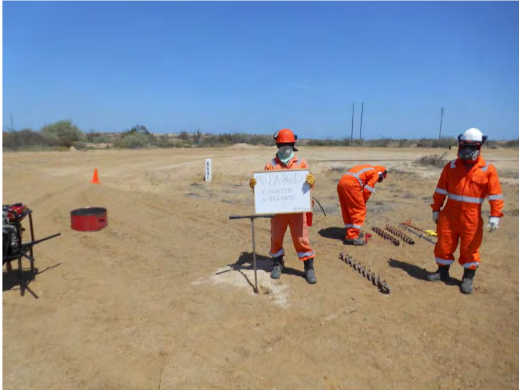
Fotografía 3. Pozo EA8631D. Muestreo de Detalle (MD-EA8631D-1). Se muestreó con intervalo de profundidad de 25cm. La profundidad máxima alcanzada fue de 1.00 metro.
