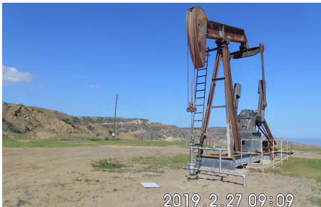
Fotografía 1. Pozo EA11072 (Coordenadas WGS84-zona 17S: 483001mE, 9531854mN), pozo productivo tipo BM. Vista desde cerca del pozo. Sin indicio de derrame de hidrocarburos ni alteración de suelo.
