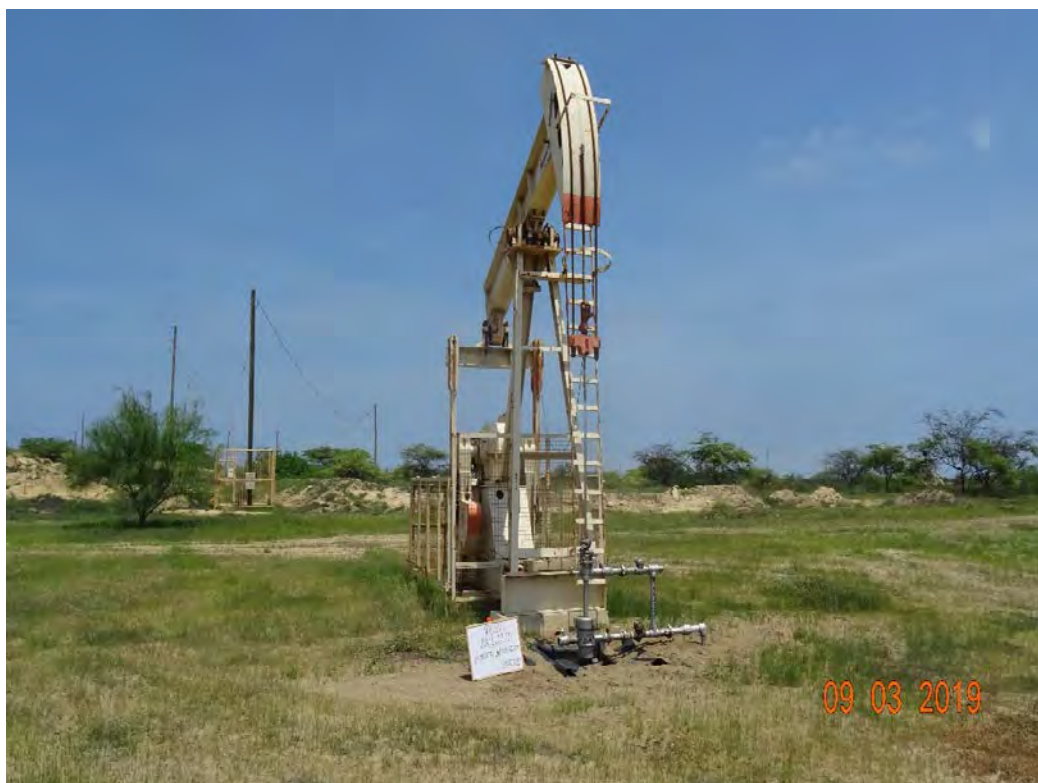
Fotografía 1. Pozo EA11332D (Coordenadas WGS84-zona 17S: 482696mE, 9530407mN), pozo productivo tipo BM. Vista desde cerca del pozo. Sin indicio de derrame de hidrocarburos ni alteración de suelo.
