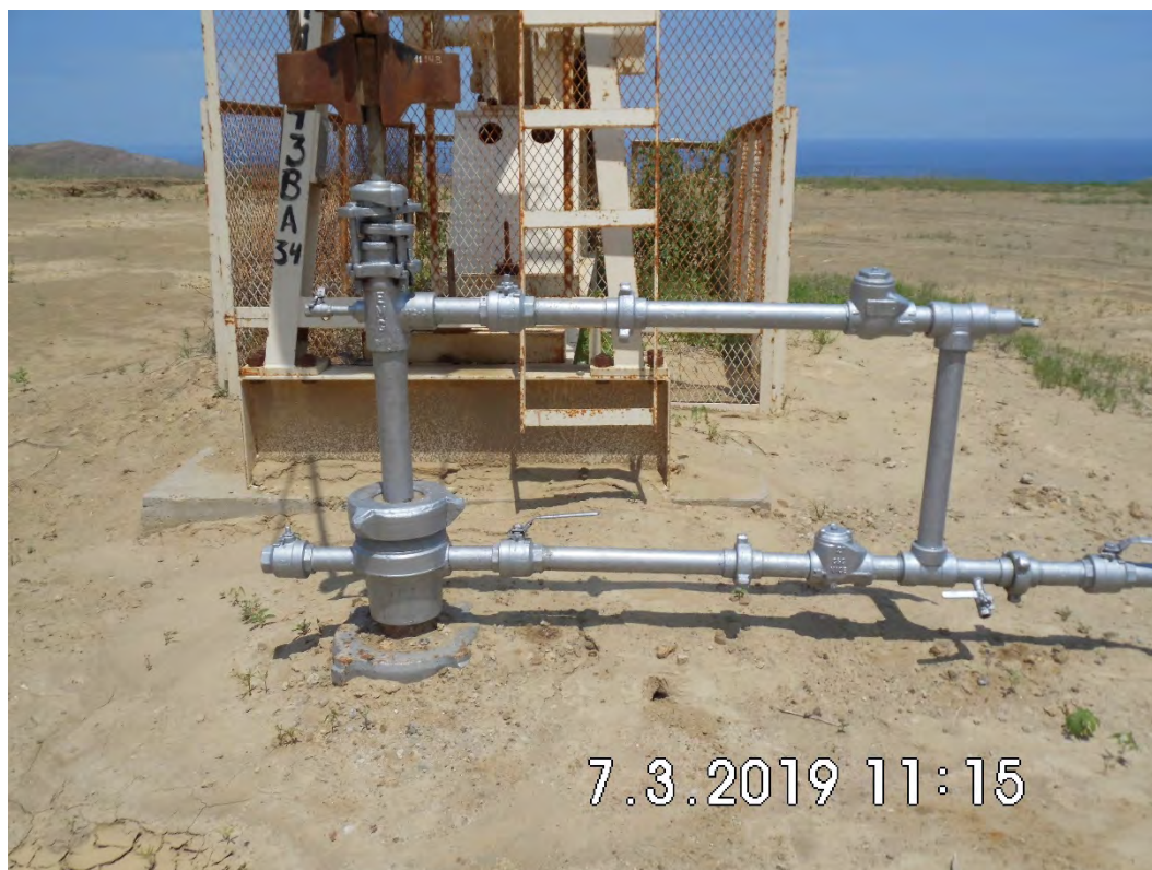
Fotografía 1. Pozo EA11143 (Coordenadas WGS84-zona 17S: 479052mE, 9531866mN), pozo productivo tipo BM. Vista desde cerca del pozo. Sin indicio de derrame de hidrocarburos ni alteración de suelo.
