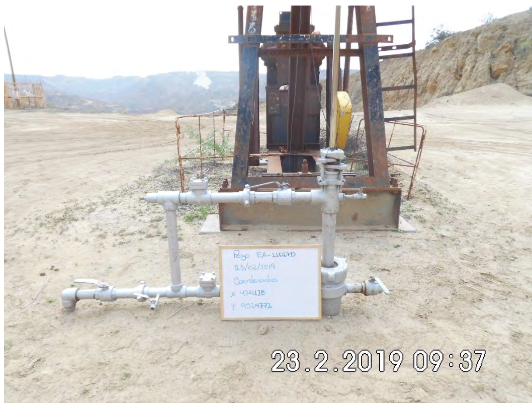
Fotografía 1. Pozo EA11027D (Coordenadas WGS84-zona 17S: 474128mE, 9524772mN), pozo productor tipo BM. Vista desde cerca del pozo.
