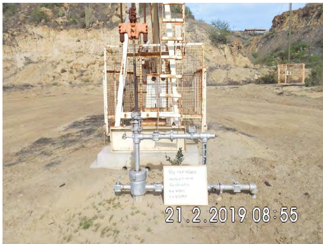
Fotografía 1. Pozo EA11338D (Coordenadas WGS84-zona 17S: 473969mE, 9525769mN), pozo productivo tipo BM. Vista desde cerca del pozo. Sin indicio de derrame de hidrocarburos ni alteración de suelo.
