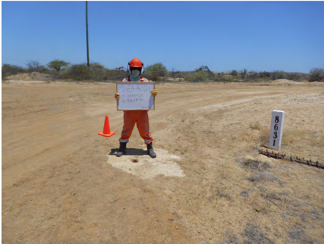
Fotografía 5. Pozo EA8631D. Muestreo de Detalle (MD-EA8631-3). Se muestreo con intervalo de profundidad de 25 cm. La profundidad máxima alcanzada fue de 1.00 metro.
