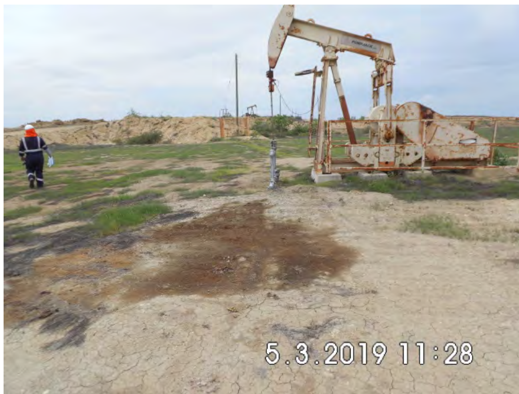
Fotografía 1. Pozo EA8932 (Coordenadas WGS84-zona 17S: 473450mE, 9525452mN), pozo productivo tipo BM. Vista desde cerca del pozo. Con indicio de derrame de hidrocarburos y alteración de suelo próximo al cabezal del pozo. El área afectada es de 16.5 m 2 aproximadamente.
