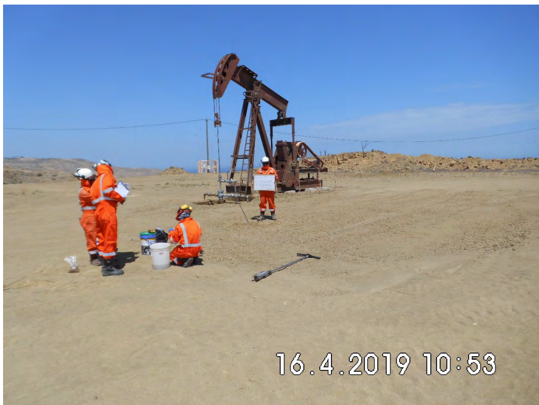
Fotografía 4. Pozo EA8939. La toma de Muestreo de Detalle en el intervalo de 0 -25 cm y 25 – 50 cm.
