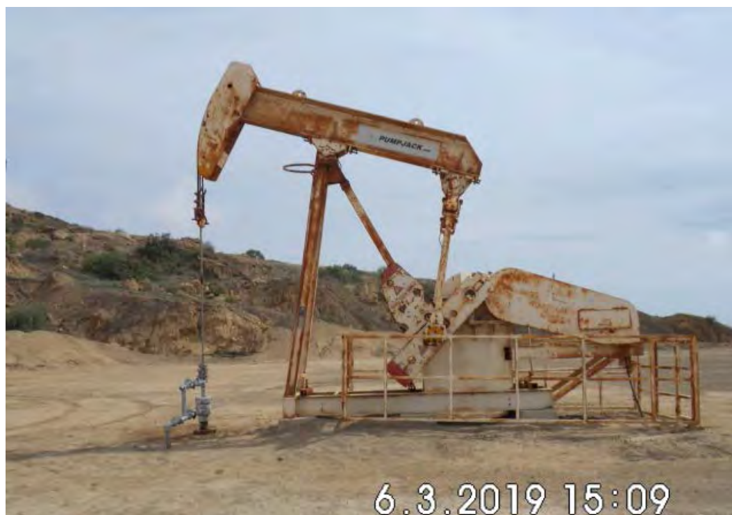
Fotografía 1. Pozo EA11198 (Coordenadas WGS84-zona 17S: 472902mE, 9526629mN), pozo productor tipo BM. Vista desde cerca del pozo. Sin indicio de derrame de hidrocarburos, ni alteración de suelo.
