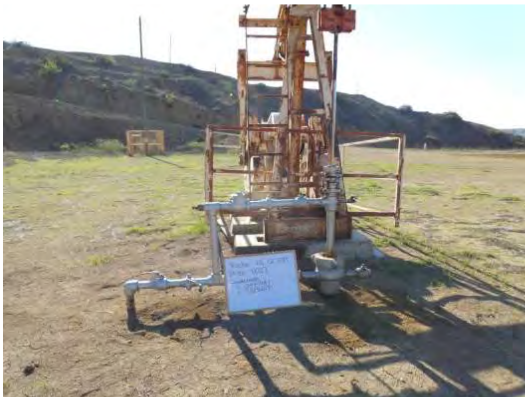
Fotografía 1. Pozo EA11003 (Coordenadas WGS84-zona 17S: 474487mE, 9525667mN), pozo productor tipo BM. Vista desde cerca del pozo. Sin indicio de derrame de hidrocarburos ni alteración de suelo.
