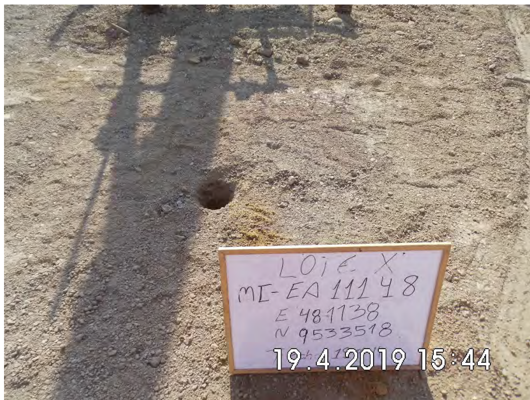
Fotografía 3. Pozo EA11148. Muestreo de Identificación (MI-EA1148). Se evaluaron muestras de 0.00-0.25 metros y de 0.25-0.50 metros de profundidad.
