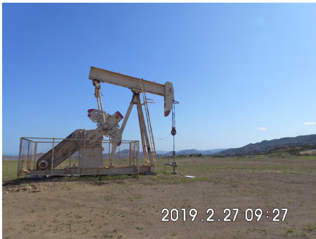
Fotografía 1. Pozo EA11079 (Coordenadas WGS84-zona 17S: 482951mE, 9532028mN), pozo productivo tipo BM. Vista desde cerca del pozo. Sin indicio de derrame de hidrocarburos ni alteración de suelo.
