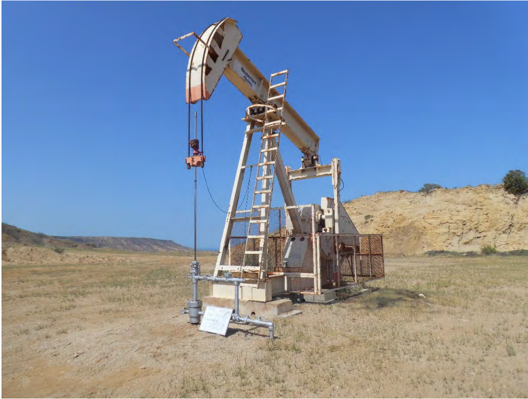
Fotografía 1. Pozo EA11272D (Coordenadas WGS84-zona 17S: 475518mE, 9524629mN), pozo productor tipo BM. Vista de cerca al pozo.
