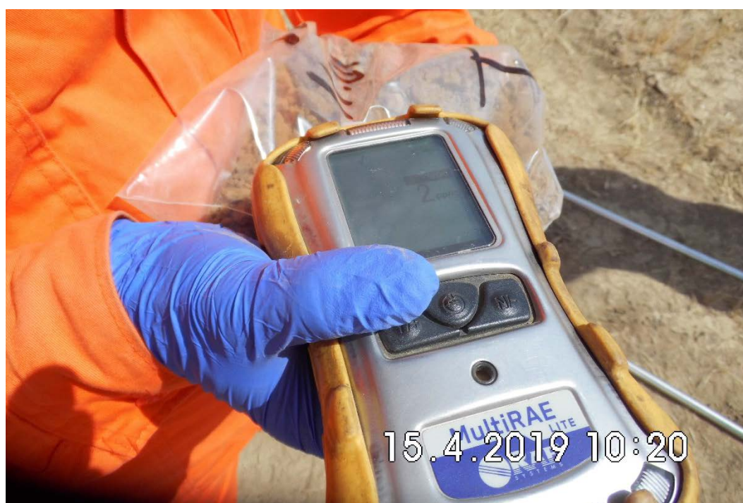
Fotografía 4. La selección de cada muestra de acuerdo a la lectura de VOC tomada en campo utilizando el PIT.
