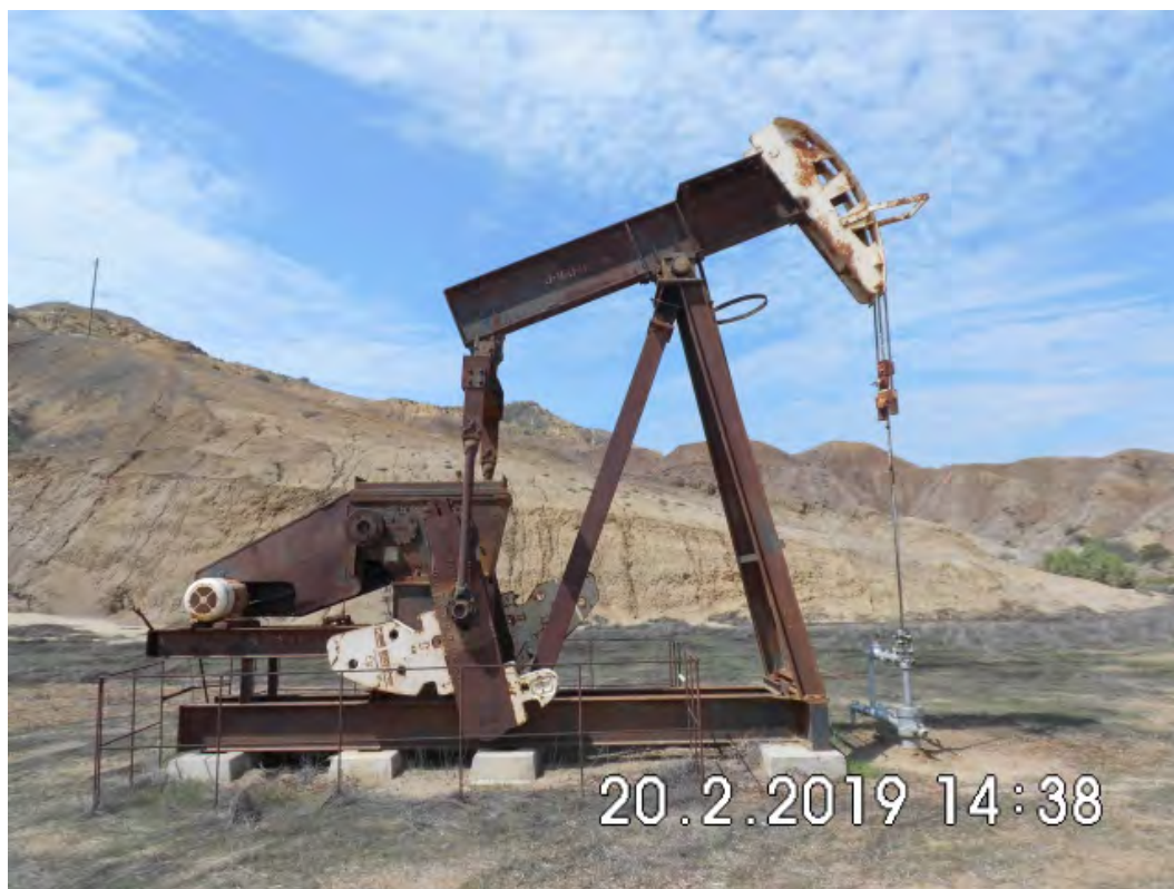
Fotografía 1. Pozo EA11169 (Coordenadas WGS84-zona 17S: 472927mE, 9523230mN), pozo productivo tipo BM. Vista desde cerca del pozo. Sin indicio de derrame de hidrocarburos ni alteración de suelo.
