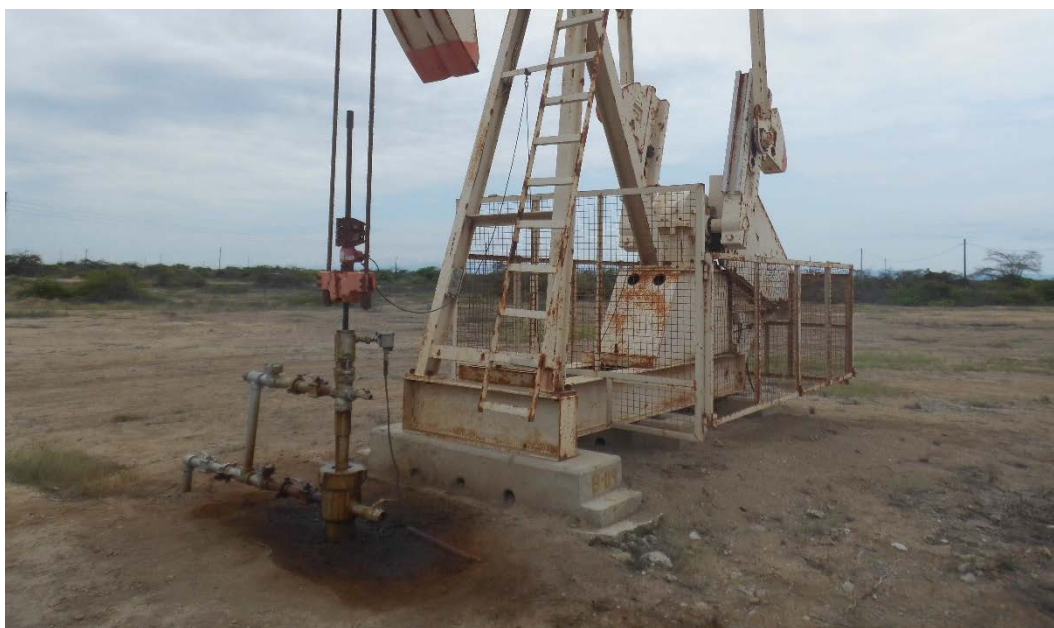
Fotografía 1. Pozo AA11373 (Coordenadas WGS84-zona 17S: 480323mE, 9514035mN), pozo productivo tipo BM. Vista desde cerca del pozo. Con indicio de derrame de hidrocarburos alrededor de la boca del pozo, el área afectada es de 1 m 2 aproximadamente.
