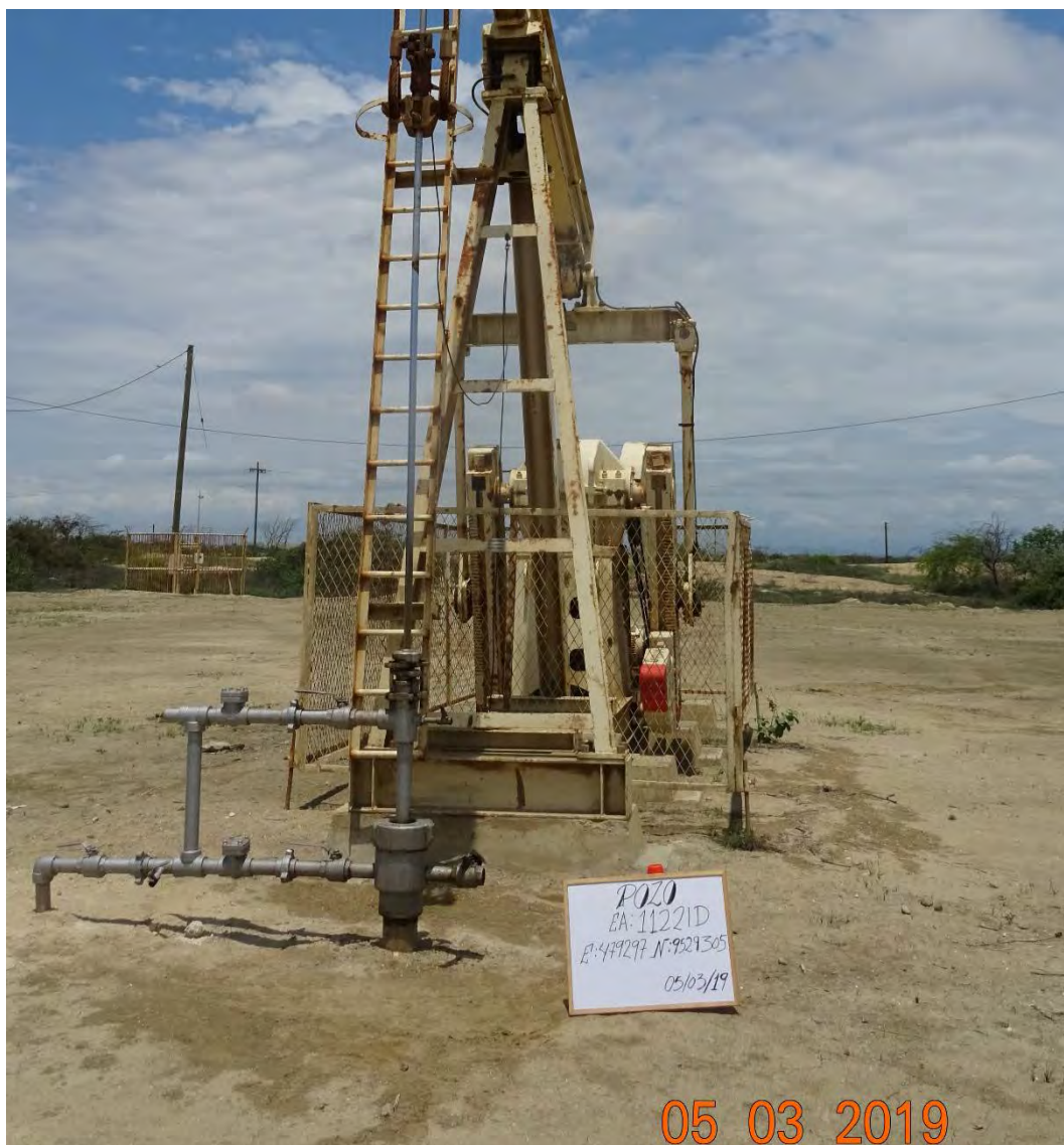
Fotografía 1. Pozo EA11221D (Coordenadas WGS84-zona 17S: 479297mE, 9529305mN), pozo productivo tipo BM. Vista desde cerca del pozo. Sin indicio de derrame de hidrocarburos ni alteración de suelo.
