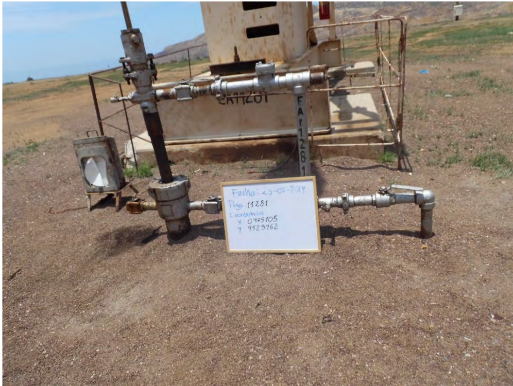
Fotografía 1. Pozo EA11281 (Coordenadas WGS84-zona 17S: 475105mE, 9523462mN), pozo productor tipo BM. Vista desde cerca del pozo. Sin indicio de derrame de hidrocarburos ni alteración de suelo.
