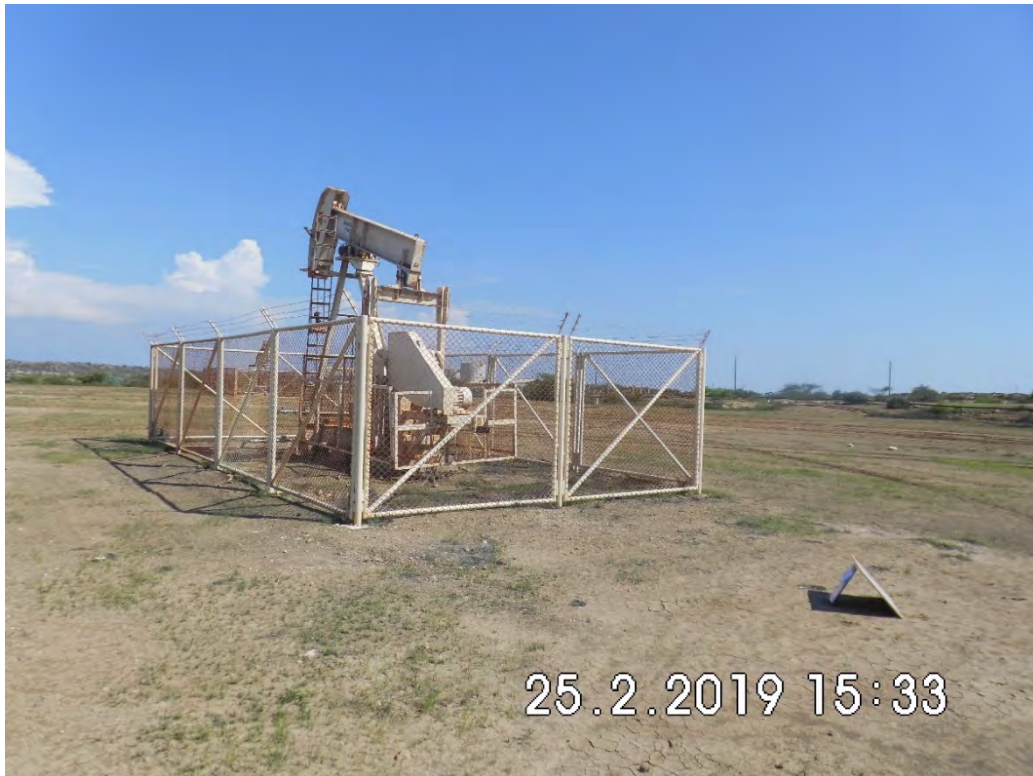
Fotografía 1. Pozo EA11317D (Coordenadas WGS84-zona 17S: 476613mE, 9527535mN), pozo productor tipo BM. Vista desde cerca del pozo.
