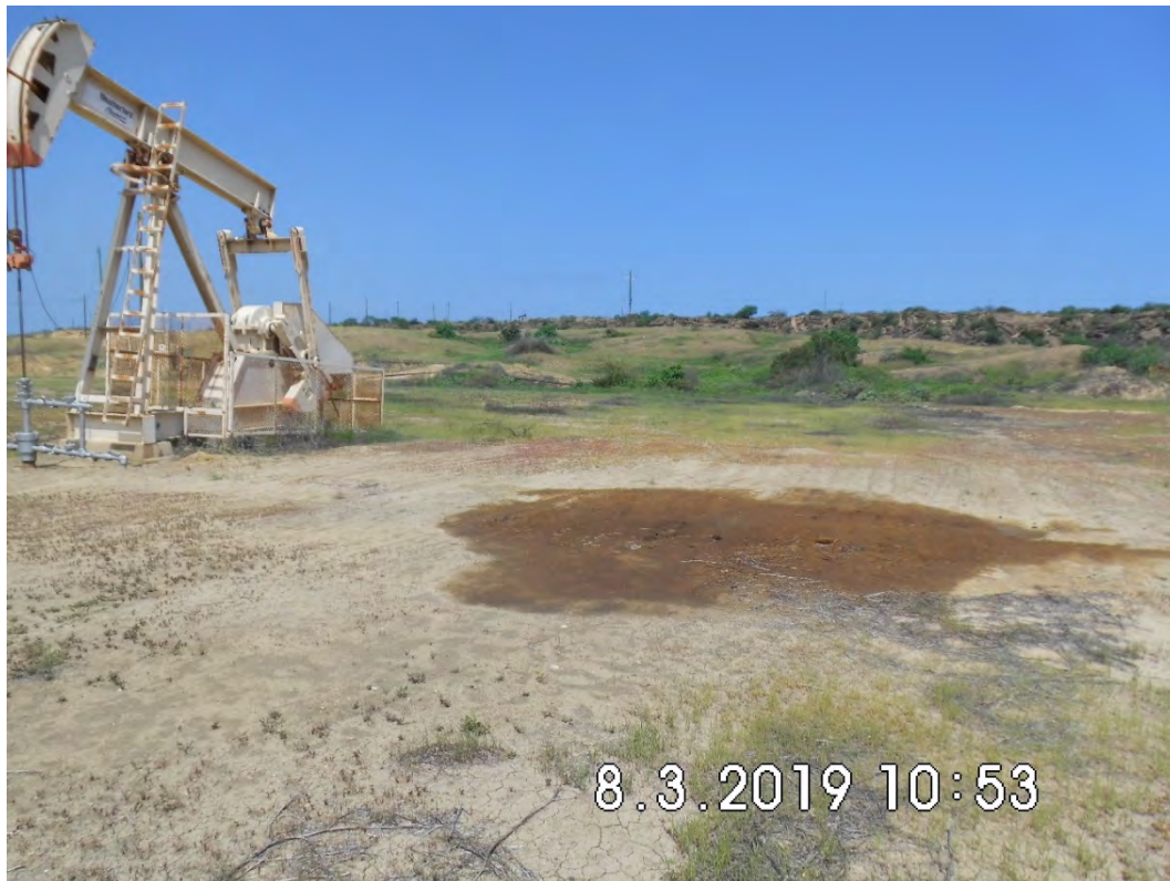
Fotografía 3. Afectación del suelo producto de la impregnación de hidrocarburos en zona muy próxima al pozo.
