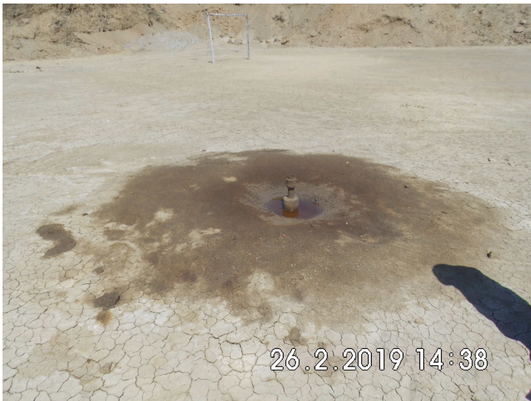
Fotografía 1. Pozo EA8081 (Coordenadas WGS84-zona 17S: 472974mE, 9528966mN). Pozo abandonado tipo ATAPET. Vista desde cerca del pozo. Suelo impregnado con hidrocarburos alrededor de la boca del pozo de 4m 2 aproximadamente.
