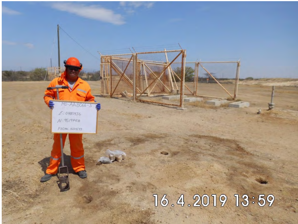
Fotografía 5. Pozo AA8066. Muestreo de Detalle (MD-AA8066-3). Se muestreo con intervalo de profundidad de 25 cm. La profundidad máxima alcanzada fue de 1 metro.
