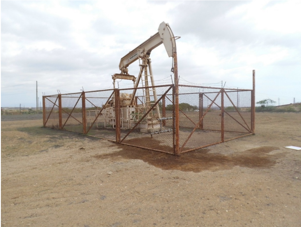
Fotografía 1. Pozo EA8099 (Coordenadas WGS84-zona 17S: 474766mE, 9527927mN), pozo productor tipo Bombeo Mecánico. Se percibe suelo impregnado de hidrocarburo de 8m 2 aproximadamente.
