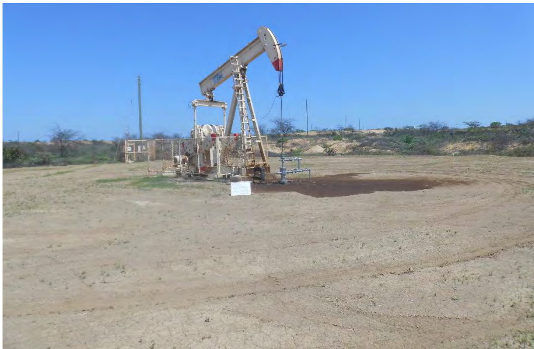
Fotografía 2. Pozo EA8926 vista panorámica de la plataforma. Se observa el suelo impregnado por hidrocarburos alrededor del pozo, el área reportada es de 4 m 2 aproximadamente.
