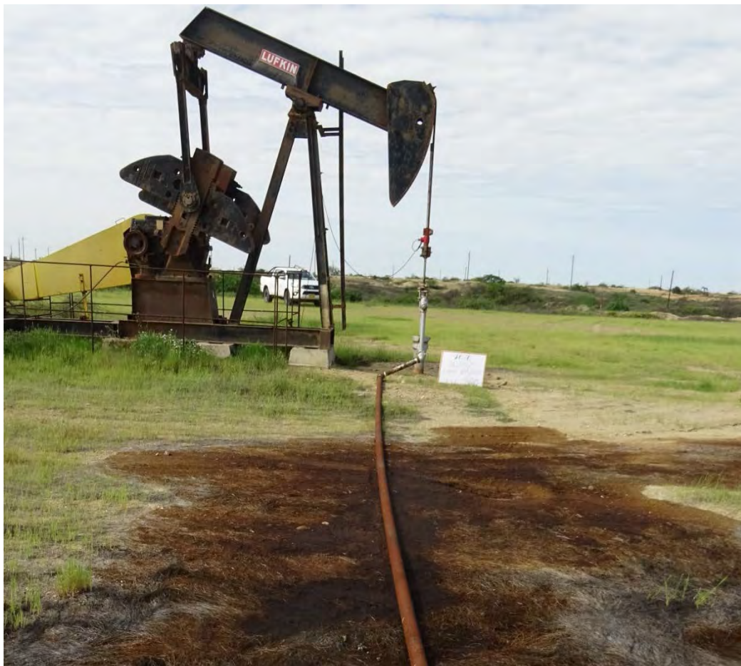
Fotografía 2. Pozo EA8523 la mancha del derrame de hidrocarburos y alteración de suelo alrededor de su ducto muy próximo al pozo.
