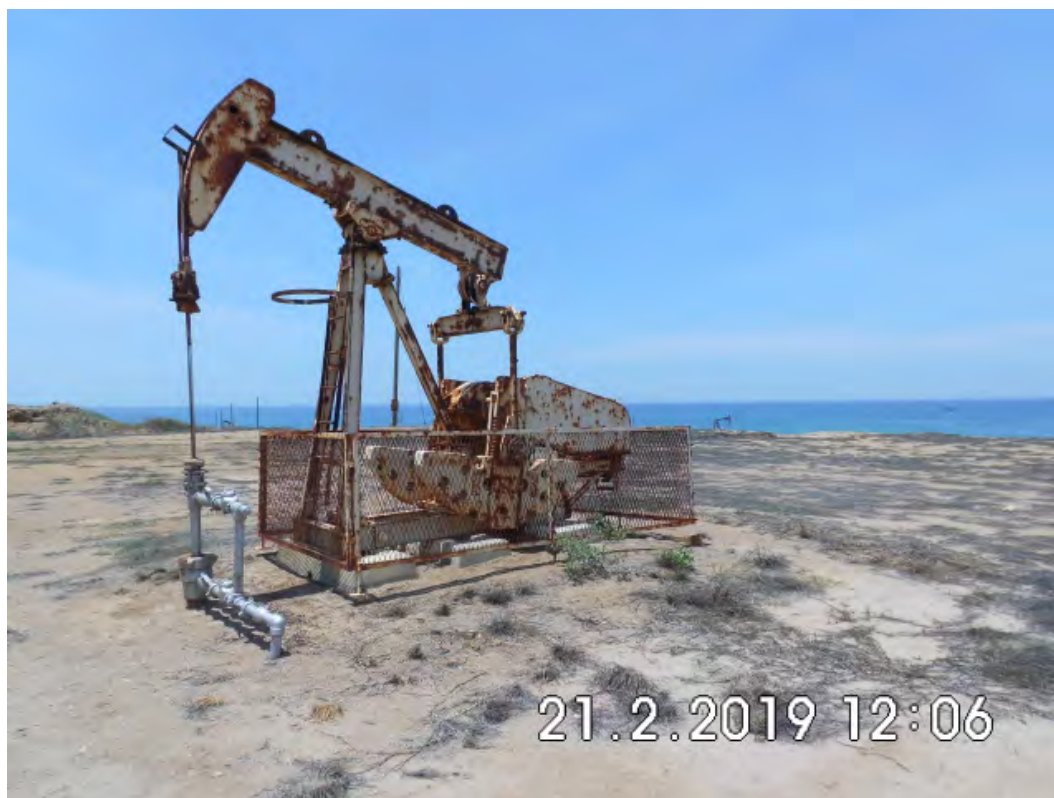
Fotografía 1. Pozo EA11036 (Coordenadas WGS84-zona 17S: 471535mE, 9523976mN), pozo productivo tipo BM. Vista desde cerca del pozo. Sin indicio de derrame de hidrocarburos ni alteración de suelo.
