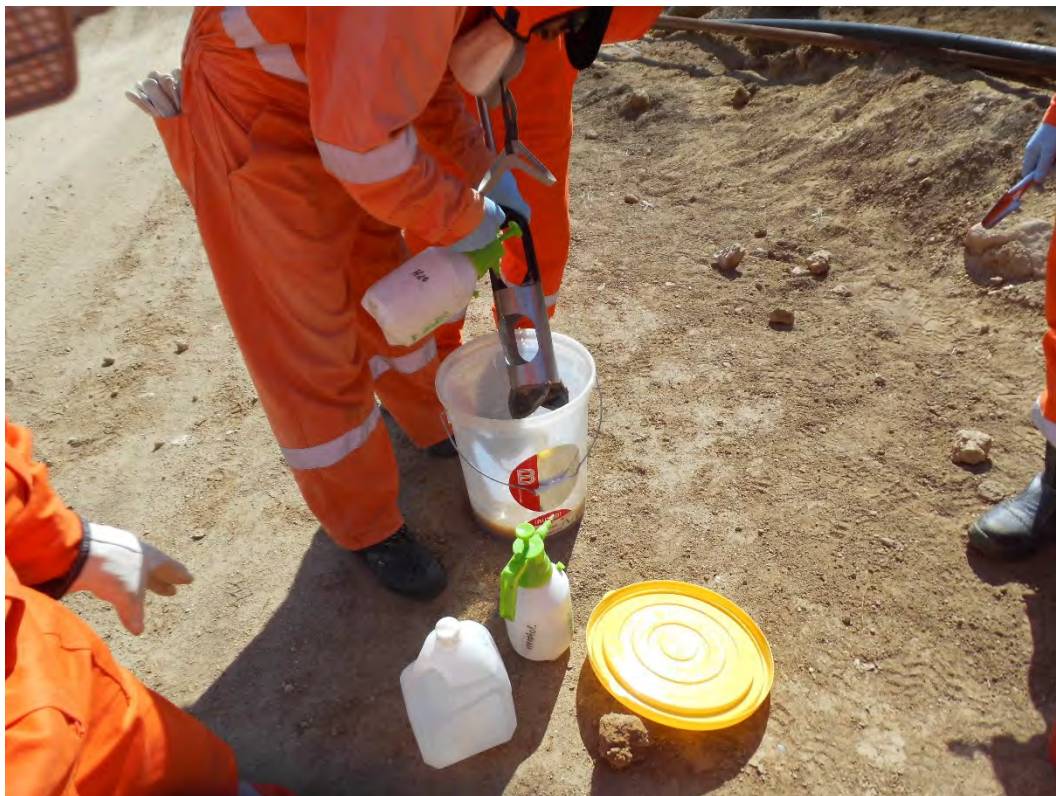
Fotografía 4. Pozo EA8714. La toma de Muestreo de Detalle en el intervalo de 0 -25 cm y 25 – 50 cm.
