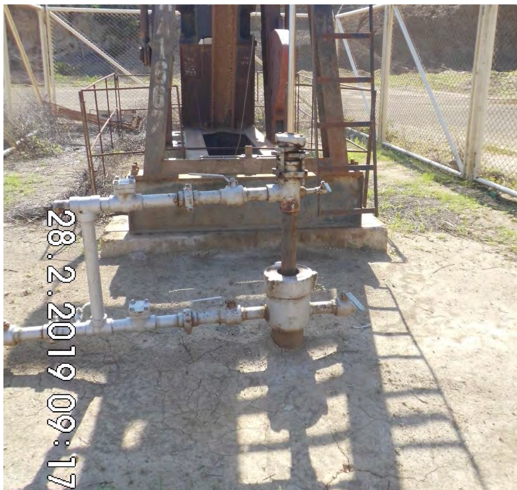
Fotografía 1. Pozo EA11174D (Coordenadas WGS84-zona 17S: 475050mE, 9528844mN), pozo productor tipo BM. Sin indicio de derrame de hidrocarburos ni alteración de suelo.
