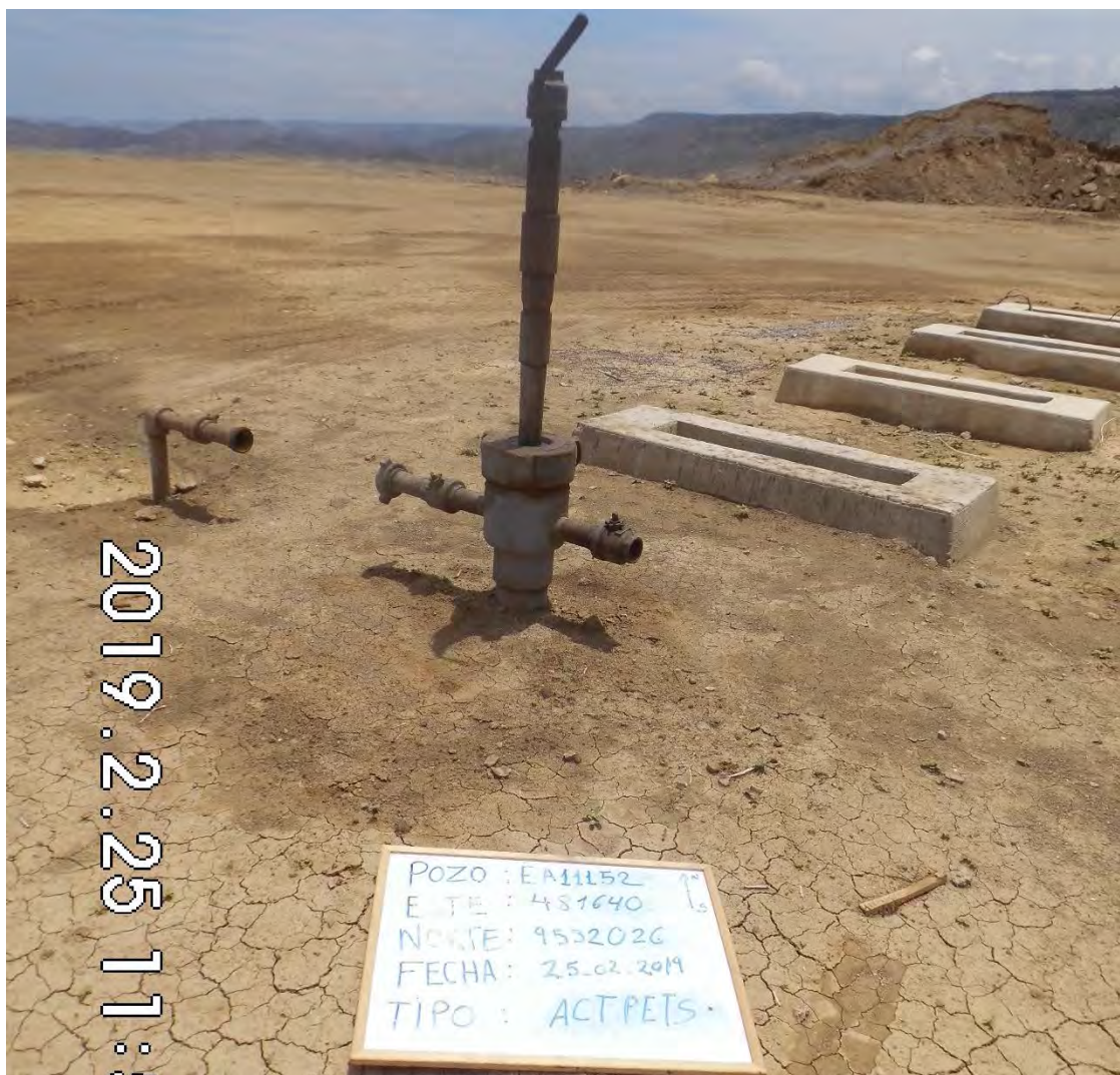
Fotografía 1. Pozo EA11152D (Coordenadas WGS84-zona 17S: 481640mE, 9532026mN), pozo productivo tipo ACTPETS. Vista desde cerca del pozo. Sin indicio de derrame de hidrocarburos ni alteración de suelo.
