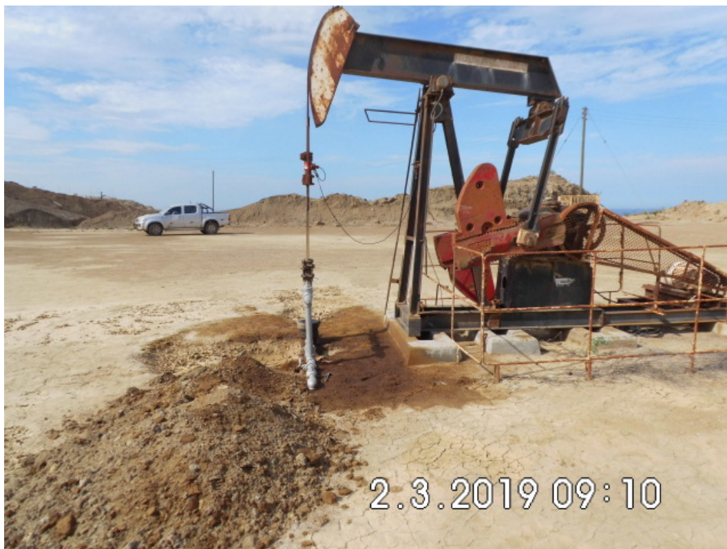
Fotografía 1. Pozo EA8913 (Coordenadas WGS84-zona 17S: 472073mE, 9526261mN), pozo productor tipo BM. Vista desde cerca del pozo. Con indicio de derrame de hidrocarburos y alteración de suelo alrededor del cabezal de pozo con un área de aproximadamente 1 m 2 .
