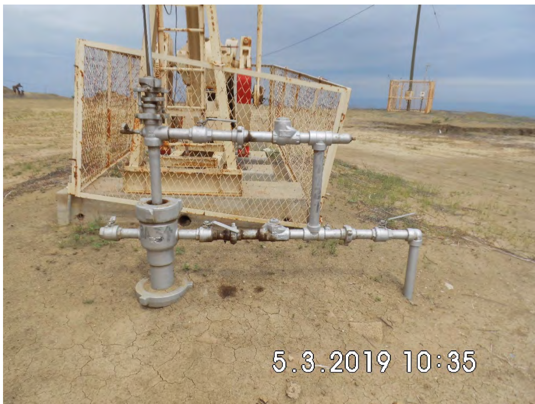
Fotografía 1. Pozo EA11121 (Coordenadas WGS84-zona 17S: 477464mE, 9531284mN), pozo productor tipo BM. Vista desde cerca del pozo.
