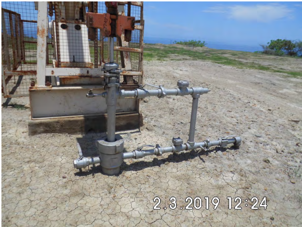
Fotografía 1. Pozo EA11306D (Coordenadas WGS84-zona 17S: 477153mE, 9530535mN), pozo productivo tipo BM. Vista desde cerca del pozo. Sin indicio de derrame de hidrocarburos ni alteración de suelo.
