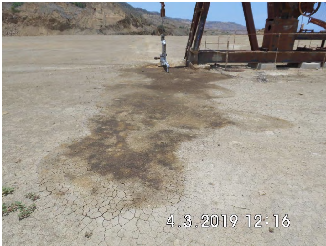
Fotografía 2. Pozo EA8939 la mancha del derrame de hidrocarburos y alteración de suelo alrededor de su ducto muy próximo al pozo.
