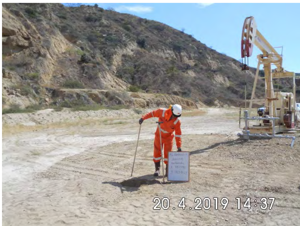
Fotografía 3. Pozo EA8333. Muestreo de Identificación (MI-EA8333-1) Coordenadas WGS84-zona 17S: 482495mE, 9531023mN. El muestreo se realizó en el intervalo de 0.00-0.25 y 0.25-0.50 metros de profundidad.
