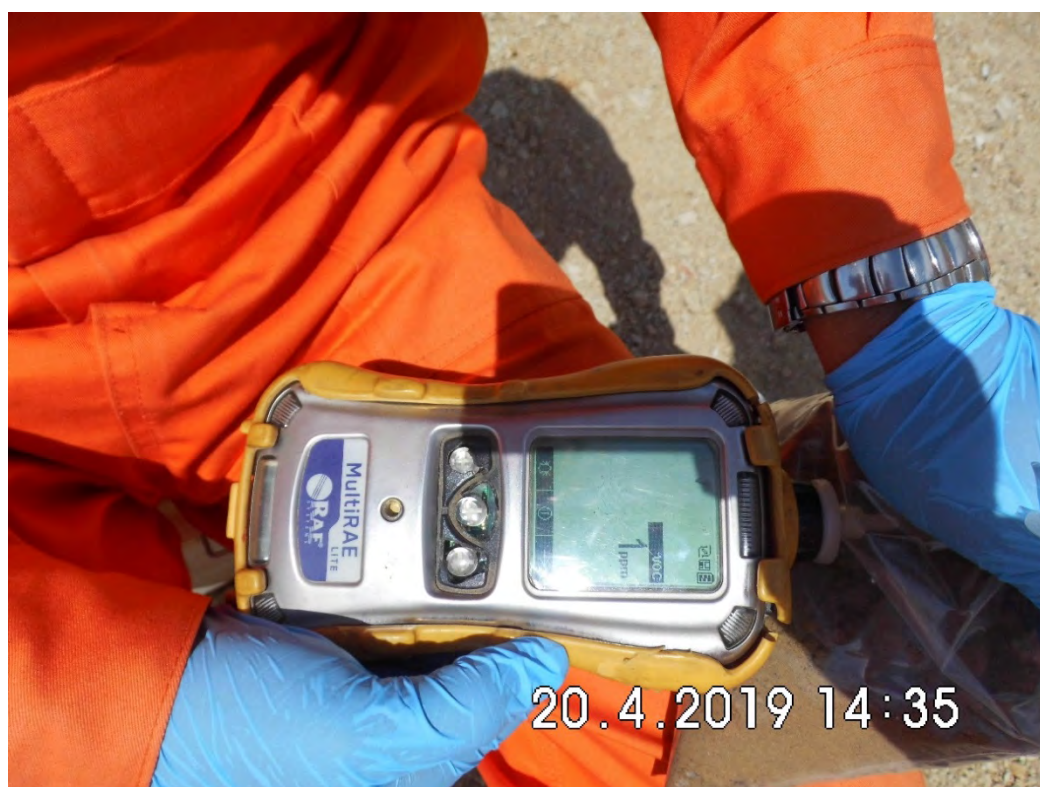
Fotografía 4. Selección de muestra de acuerdo a la lectura de VOC tomada en campo utilizando el PIT.
