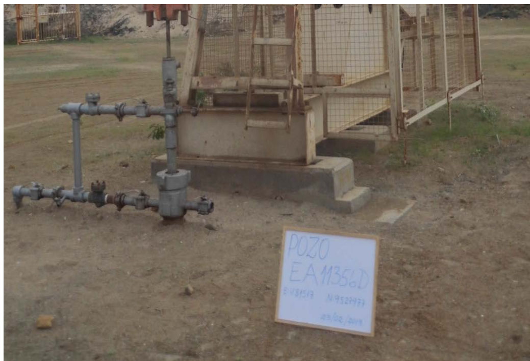
Fotografía 1. Pozo EA11356D (Coordenadas WGS84-zona 17S: 481517mE, 9527977mN), pozo productivo tipo BM. Vista desde cerca del pozo. Sin indicio de derrame de hidrocarburos ni alteración de suelo.
