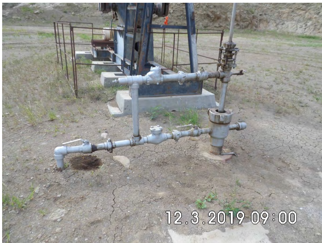
Fotografía 1. Pozo EA11064 (Coordenadas WGS84-zona 17S: 481357mE, 9533251mN), pozo productor tipo BM. Sin indicio de derrame de hidrocarburos ni alteración de suelo.
