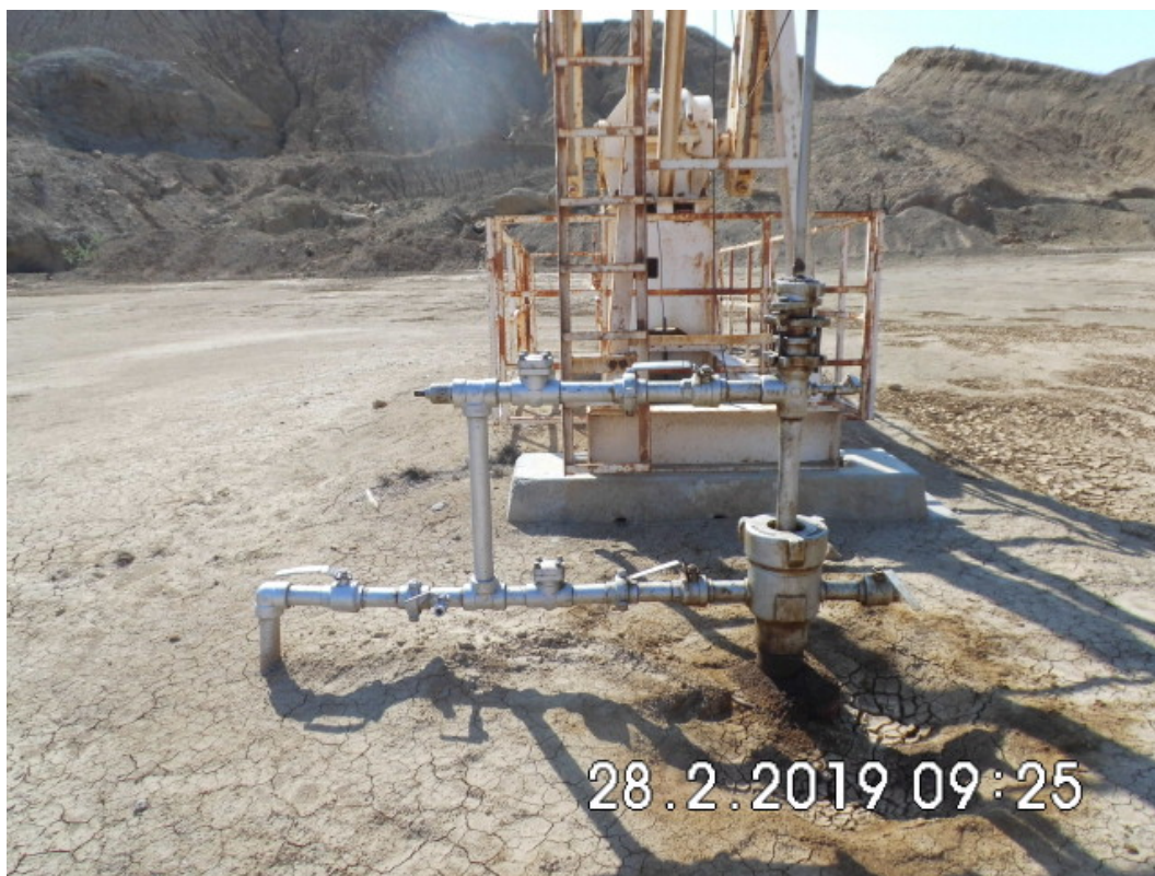
Fotografía 1. Pozo EA8951 (Coordenadas WGS84-zona 17S: 472441mE, 9525416mN), pozo productor tipo BM. Vista desde cerca del pozo. Con indicio de derrame de hidrocarburos y alteración de suelo alrededor del cabezal de pozo con un área de aproximadamente 3 m 2 .
