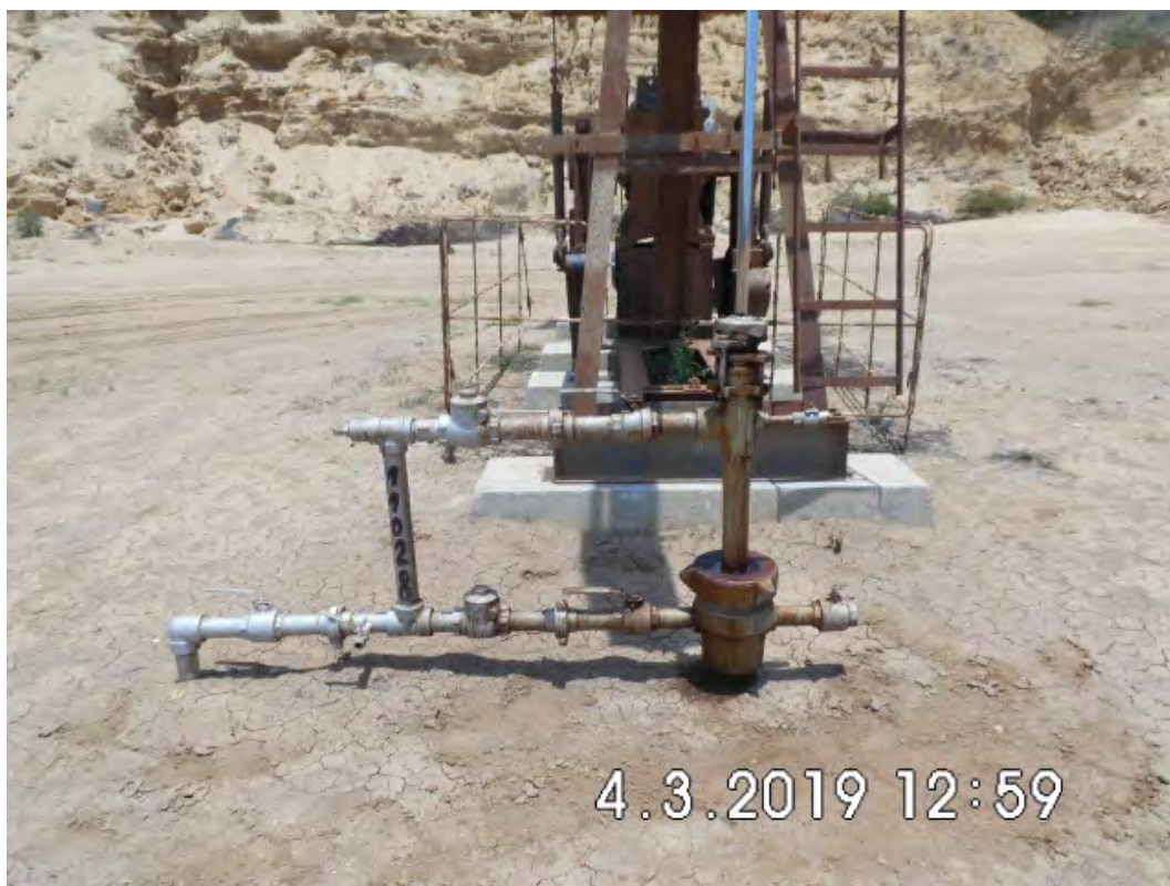
Fotografía 1. Pozo EA11028 (Coordenadas WGS84-zona 17S: 473292mE, 9525370mN), pozo productor tipo BM. Vista desde cerca del pozo.
