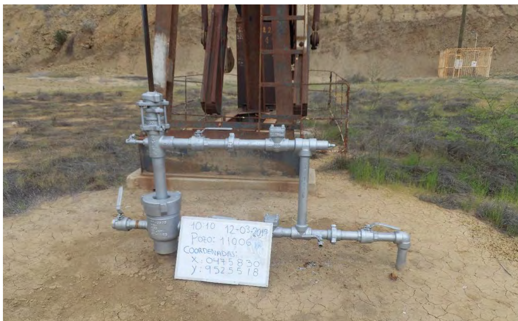
Fotografía 1. Pozo EA11006D (Coordenadas WGS84-zona 17S: 475830mE, 9525518mN), pozo productivo tipo BM. Vista desde cerca del pozo. Sin indicio de derrame de hidrocarburos ni alteración de suelo.
