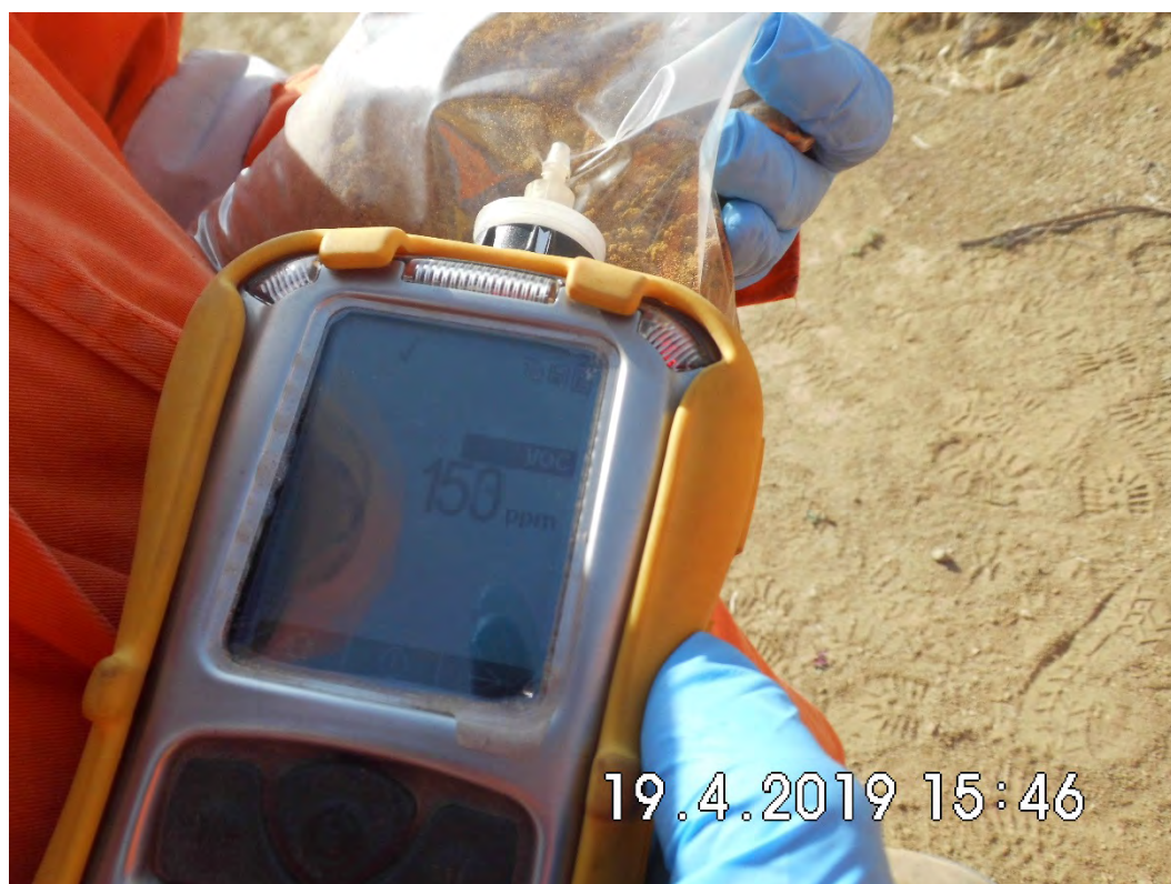
Fotografía 4. Selección de muestra de acuerdo a la lectura de VOC tomada en campo utilizando el PID.
