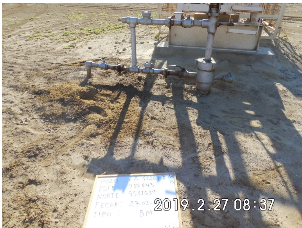
Fotografía 1. Pozo EA11267D (Coordenadas WGS84-zona 17S: 474943mE, 9525900mN), pozo productor tipo BM. Vista desde cerca del pozo. Con indicio de derrame de hidrocarburos y alteración de suelo alrededor de la cabeza del pozo. El área afectada es de 1 m 2 aproximadamente.
