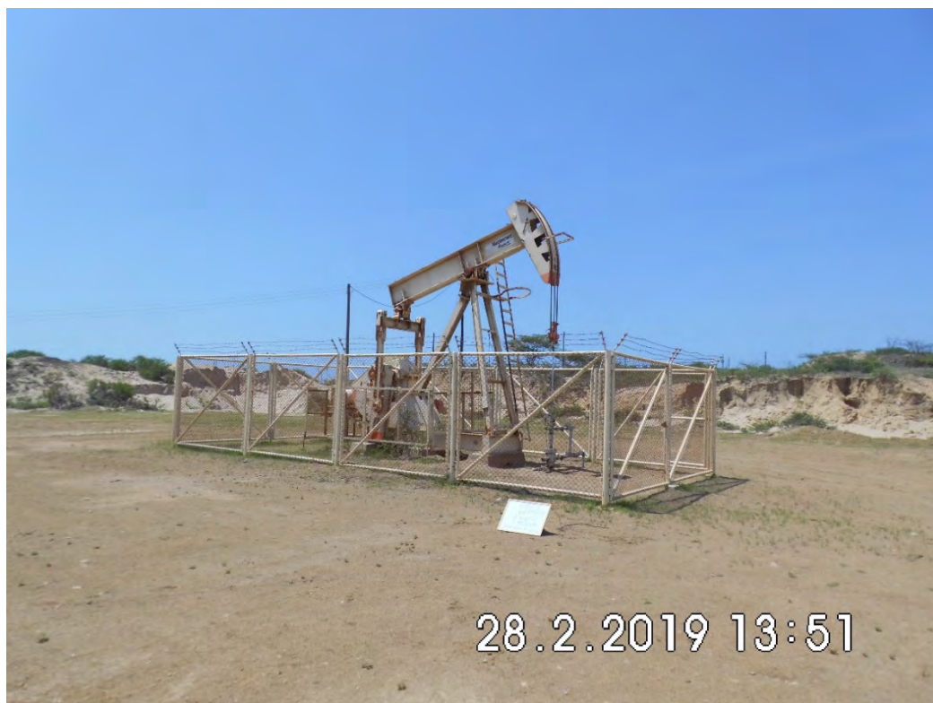
Fotografía 1. Pozo EA11311D (Coordenadas WGS84-zona 17S: 478175mE, 9527868mN), pozo productor tipo BM. Sin indicio de derrame de hidrocarburos ni alteración de suelo.
