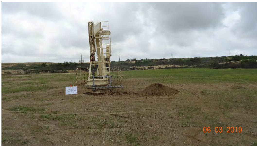
Fotografía 2. Pozo EA8608 - la mancha del derrame de hidrocarburos y alteración de suelo alrededor de la cabeza del pozo.
