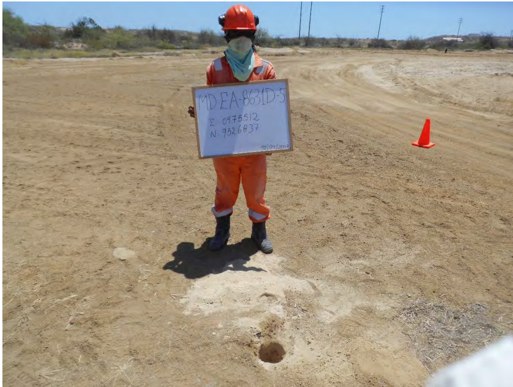
Fotografía 7. Pozo EA8631D. Muestreo de Detalle (MD-AA8066-5). Se muestreó con intervalo de profundidad de 25 cm. La profundidad máxima alcanzada fue de 1.00 metro.
