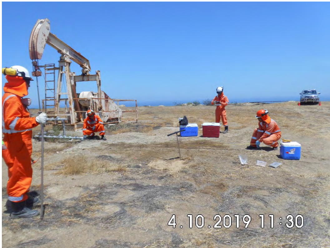
Fotografía 3. Medición e inventario del área de suelo afectado por hidrocarburos.
