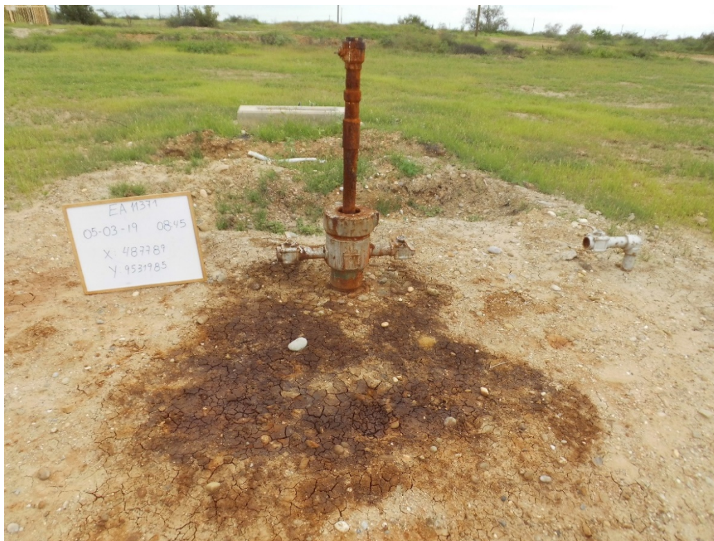
Fotografía 1. Pozo EA11371 (Coordenadas WGS84-zona 17S: 487789mE, 9531985mN), pozo cerrado o inactivo tipo INCATBM. Vista desde cerca del pozo. Con indicio de derrame de hidrocarburos y alteración de suelo alrededor del cabezal de pozo. El área afectada es de 1 m 2 aproximadamente.
