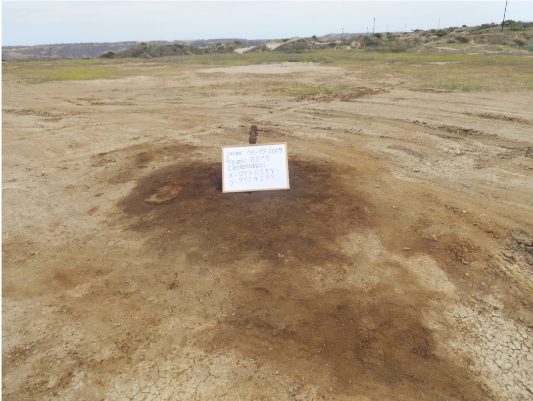
Fotografía 1. Pozo EA8243 (Coordenadas WGS84-zona 17S: 476559mE, 9524294mN), pozo productor tipo ACTPETF. Vista de cerca al pozo. Suelo impregnado con hidrocarburo aproximadamente 2m 2 .
