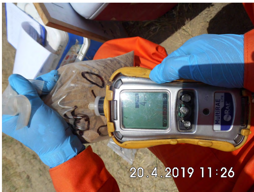
Fotografía 5. La selección de cada muestra de acuerdo a la lectura de VOC tomada en campo utilizando el PIT.
