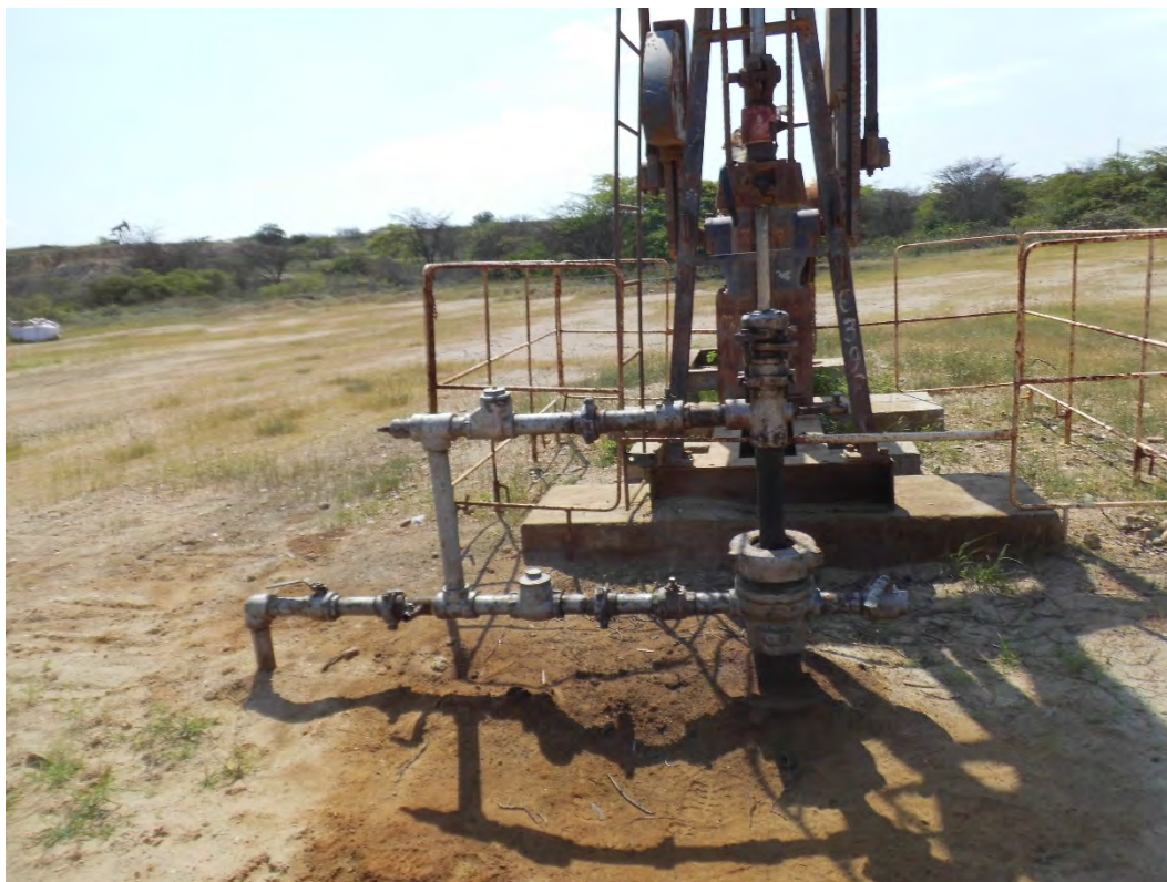
Fotografía 2. Pozo EA8588 la mancha del derrame de hidrocarburos y alteración de suelo alrededor de su ducto muy próximo al pozo.
