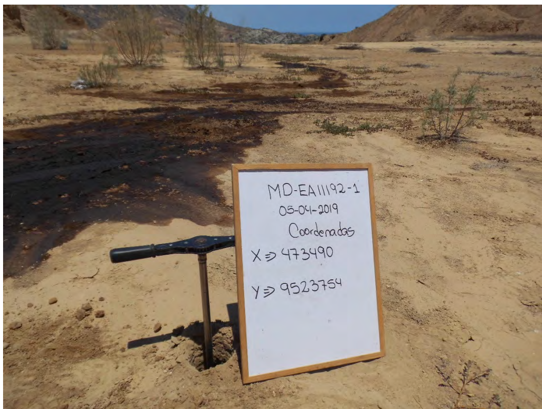
Fotografía 4. Pozo EA11192. La toma de Muestreo de Detalle en el intervalo de 0 -25 cm y 25 – 300 cm.
