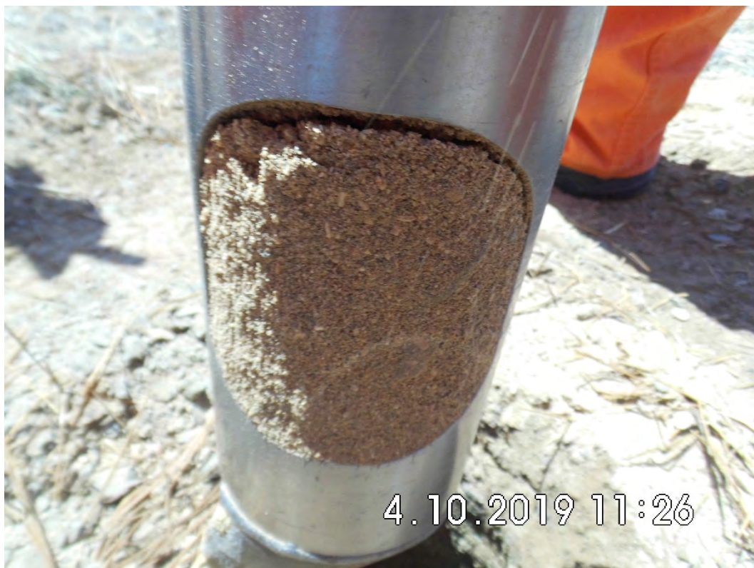
Fotografía 4. Pozo EA8714. La toma de Muestreo de Detalle en el intervalo de 75 – 100 cm.
