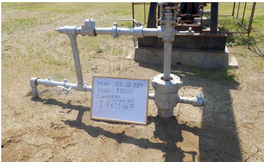
Fotografía 1. Pozo EA11018 (Coordenadas WGS84-zona 17S: 475404mE, 9525167mN), pozo productor tipo BM. Vista desde cerca del pozo. Sin indicio de derrame de hidrocarburos ni alteración de suelo.
