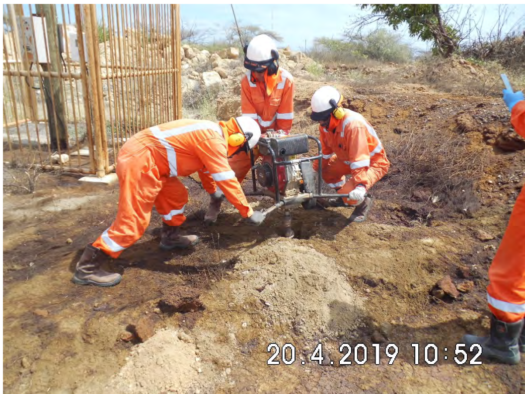
Fotografía 4. Pozo EA11086. La toma de Muestreo de Detalle en el intervalo de 0 -25 cm y 25 – 50 cm.
