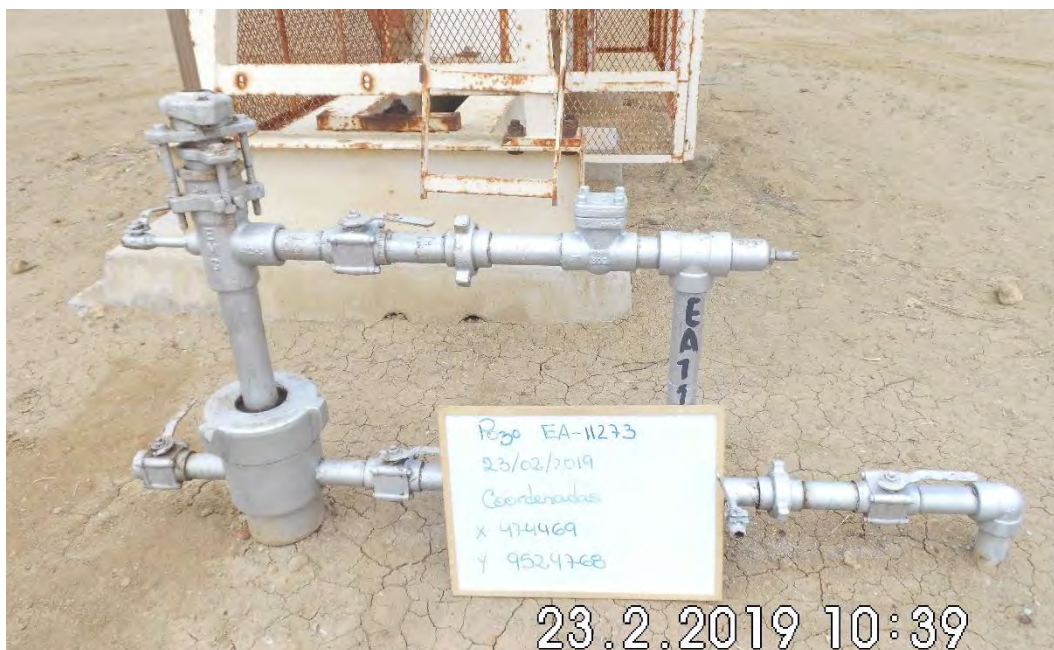
Fotografía 1. Pozo EA11273 (Coordenadas WGS84-zona 17S: 474469mE, 9524768mN), pozo productor tipo BM. Vista desde cerca del pozo. Sin indicio de derrame de hidrocarburos ni alteración de suelo.
