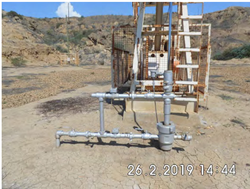
Fotografía 1. Pozo EA11316 (Coordenadas WGS84-zona 17S: 472780mE, 9525110mN), pozo productor tipo BM. Sin indicio de derrame de hidrocarburos ni alteración de suelo.
