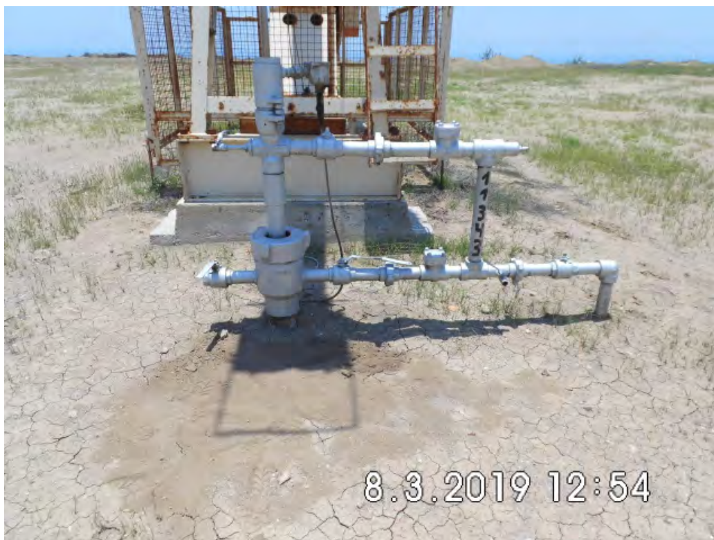
Fotografía 1. Pozo EA11343 (Coordenadas WGS84-zona 17S: 473300mE, 9526018mN), pozo productor tipo BM. Vista desde cerca del pozo. Sin indicio de derrame de hidrocarburos ni alteración de suelo.
