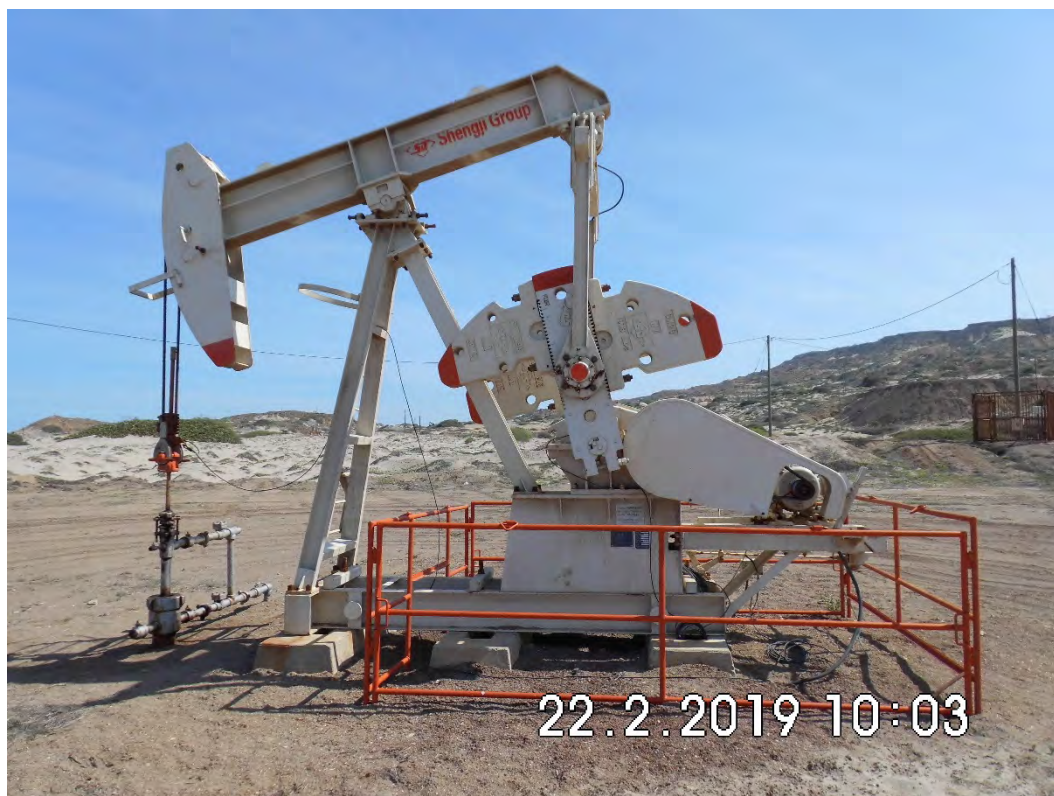
Fotografía 1. Pozo EA11031D (Coordenadas WGS84-zona 17S: 471778mE, 9523241mN), pozo productivo tipo BM. Vista desde cerca del pozo. Sin indicio de derrame de hidrocarburos ni alteración de suelo.
