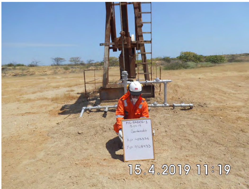
Fotografía 3. Pozo EA8106. Muestreo de Identificación (MI-EA8106-1). Se muestreo con intervalo de profundidad de 0.00-0.25m y 0.25-0.50m.
