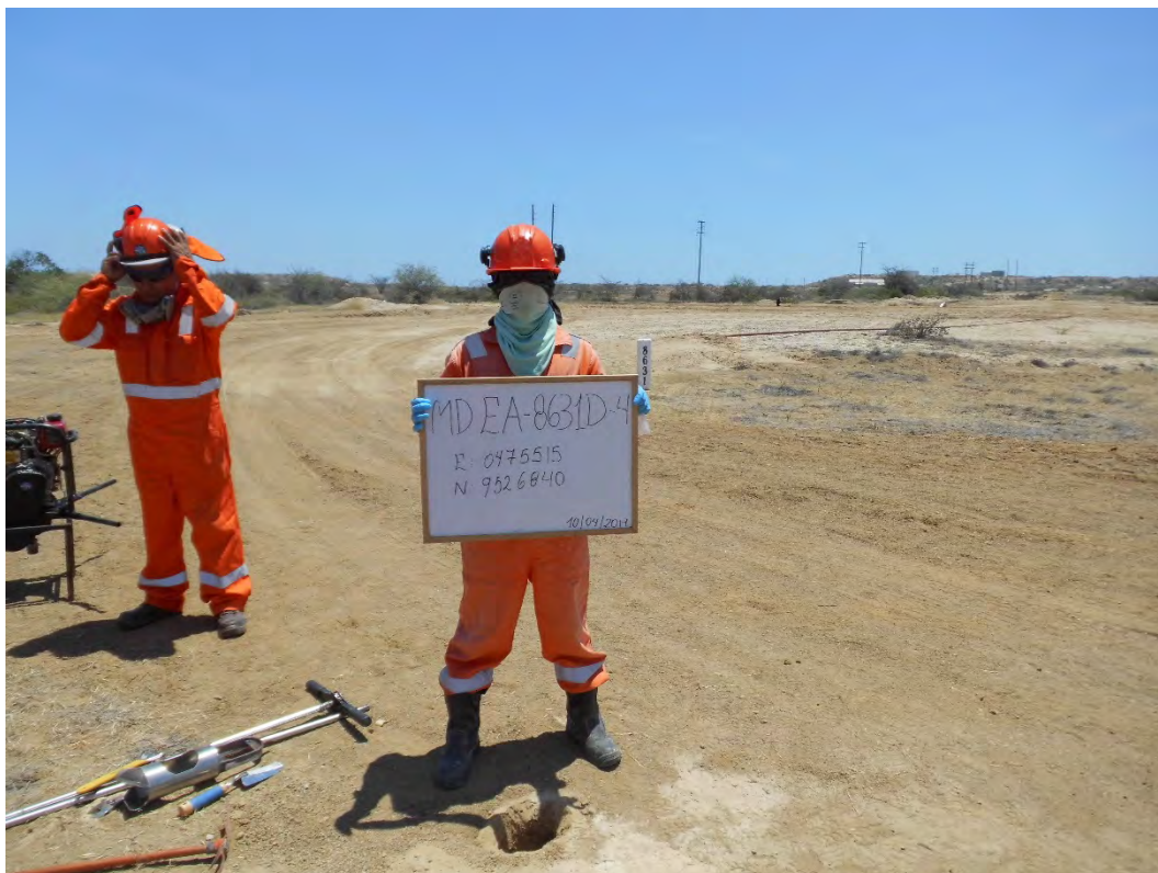
Fotografía 6. Pozo EA8631D. Muestreo de Detalle (MD-EA8631D-4). Se muestreó con intervalo de profundidad de 25 cm. La profundidad máxima alcanzada fue de 1.00 metro.
