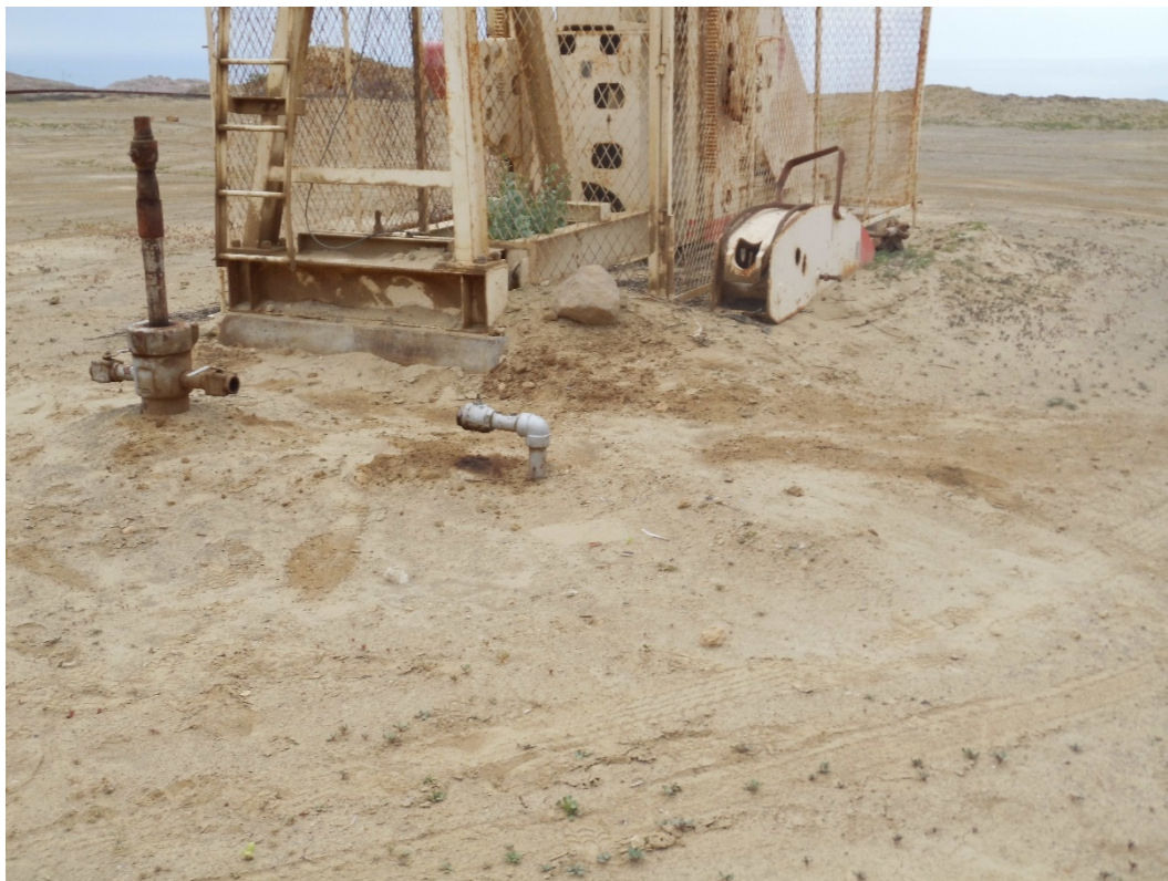
Fotografía 1. Pozo EA8983D (Coordenadas WGS84-zona 17S: 474269mE, 9527573mN), pozo productor tipo BM. Vista desde cerca del pozo. Con indicio de derrame de hidrocarburos y alteración de suelo alrededor del cabezal de pozo con un área de aproximadamente 2 m 2 .
