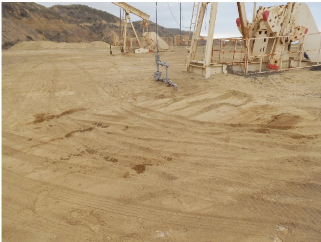
Fotografía 1. Pozo EA8981D (Coordenadas WGS84-zona 17S: 474676mE, 9528608mN), pozo productor tipo BM. Vista desde cerca del pozo. Con indicio de derrame de hidrocarburos y alteración de suelo alrededor del cabezal de pozo con un área de aproximadamente 4 m 2 .
