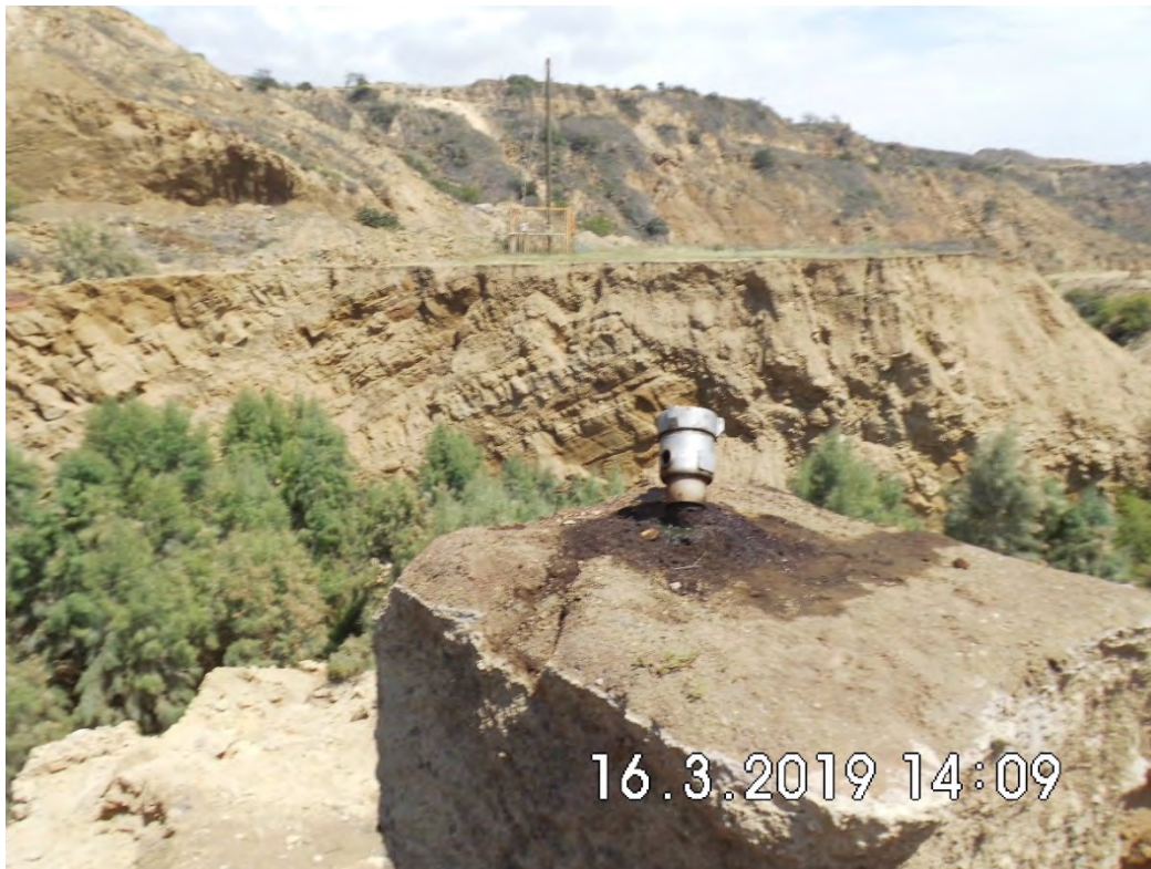
Fotografía 1. Pozo EA11022 (Coordenadas WGS84-zona 17S: 476928mE, 9526913mN), pozo inactivo tipo BM. Vista desde cerca del pozo. Con indicio de derrame de hidrocarburos, se observa la alteración de suelo.
