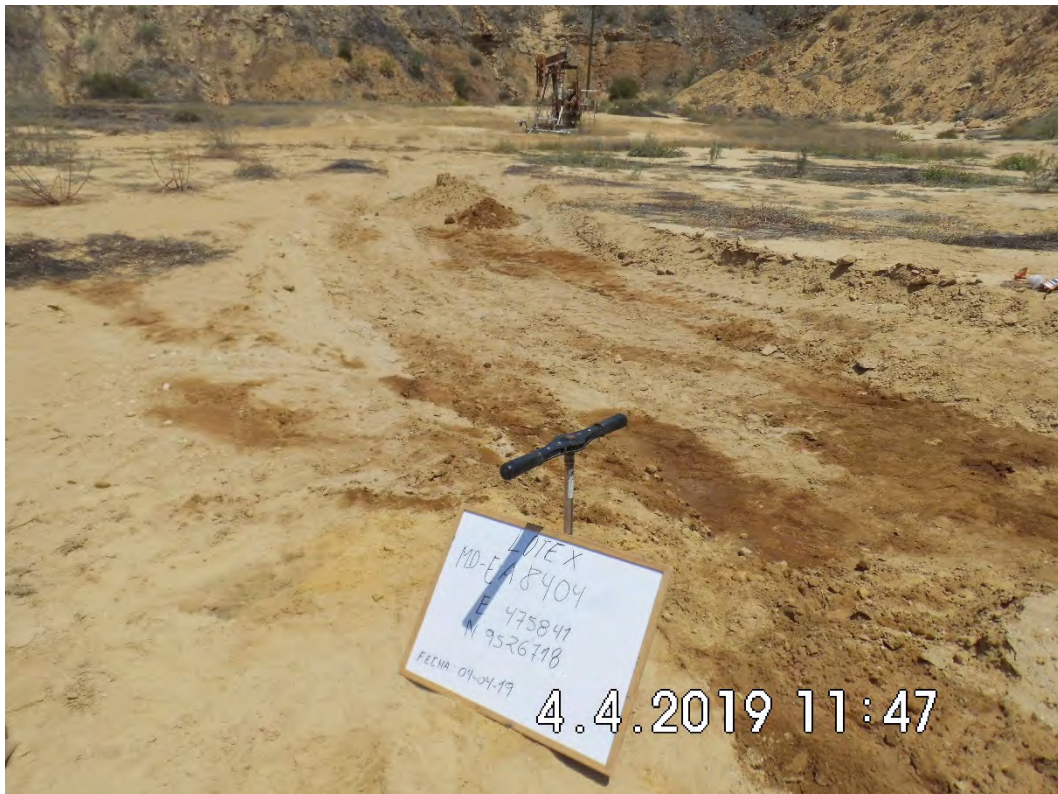
Fotografía 4. Pozo EA8404. La toma de Muestreo de Detalle en el intervalo de 0 -25 cm y 25 – 300 cm.
