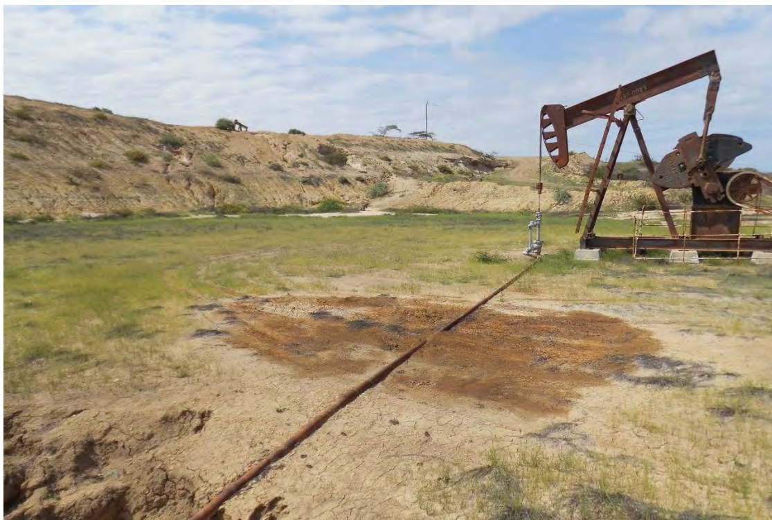
Fotografía 2. Pozo EA8714 la mancha del derrame de hidrocarburos y alteración de suelo alrededor de su ducto muy próximo al pozo. El área afectada de aproximadamente 10 m 2 .
