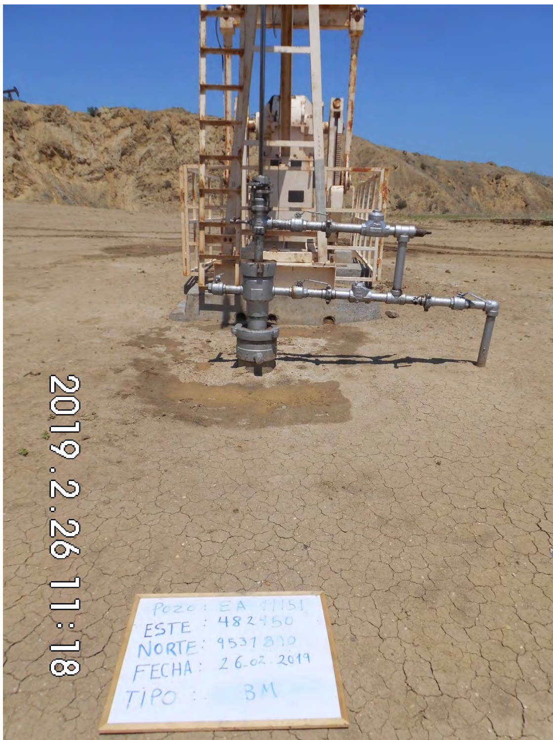
Fotografía 1. Pozo EA11151 (Coordenadas WGS84-zona 17S: 482450mE, 9531890mN), pozo productivo tipo BM. Vista desde cerca del pozo. Sin indicio de derrame de hidrocarburos ni alteración de suelo.
