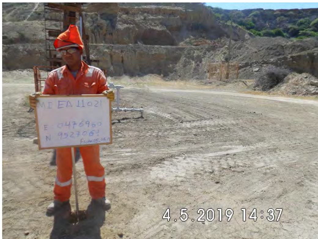
Fotografía 2. Pozo EA11021. Primer punto de muestreo de identificación en el intervalo de 0-25 cm y 25 – 50 cm.
