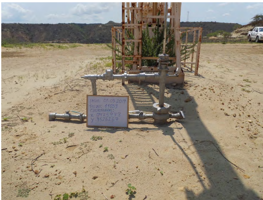
Fotografía 1. Pozo EA11053 (Coordenadas WGS84-zona 17S: 475973mE, 9526267mN), pozo productor tipo BM. Sin indicio de derrame de hidrocarburos ni alteración de suelo.
