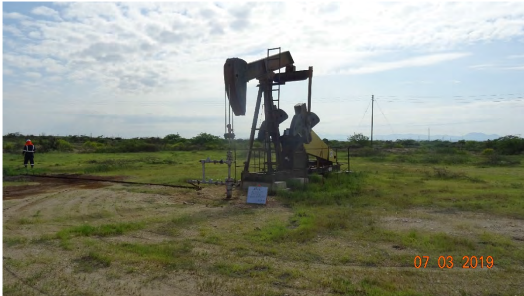
Fotografía 1. Pozo EA8523 (Coordenadas WGS84-zona 17S: 481880mE, 9529770mN), pozo productor tipo BM. Vista desde cerca del pozo.
