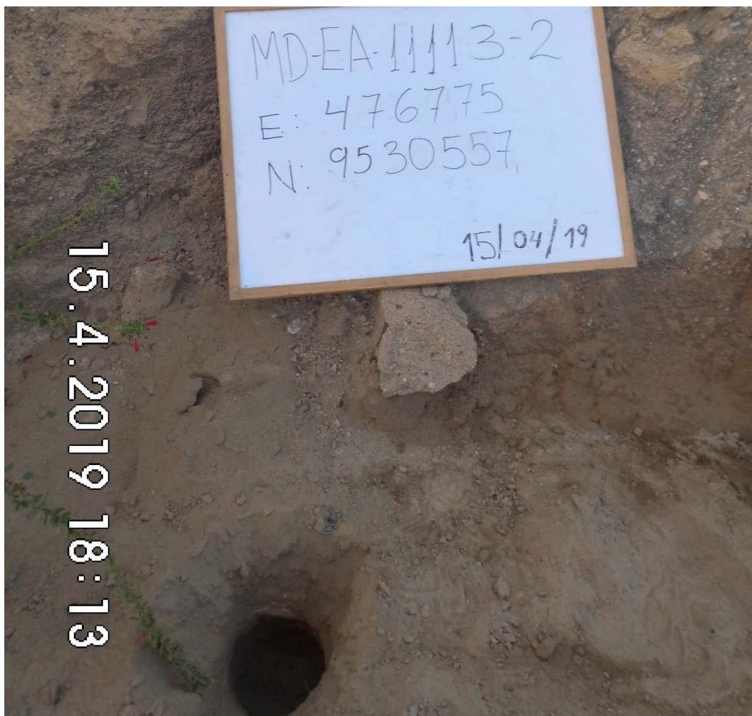
Fotografía 4. Pozo EA11113. La toma de Muestreo de Detalle en el intervalo de 0 -25 cm y 25 – 75 cm.
