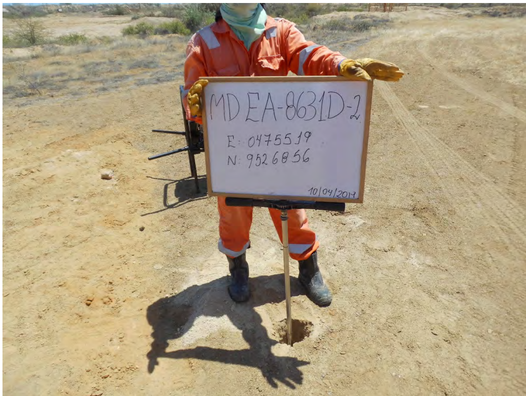
Fotografía 4. Pozo EA8631D. Muestreo de Detalle (MD-EA8631D-2). Se muestreó con intervalo de profundidad de 25cm. La profundidad máxima alcanzada fue de 1.00 metro.
