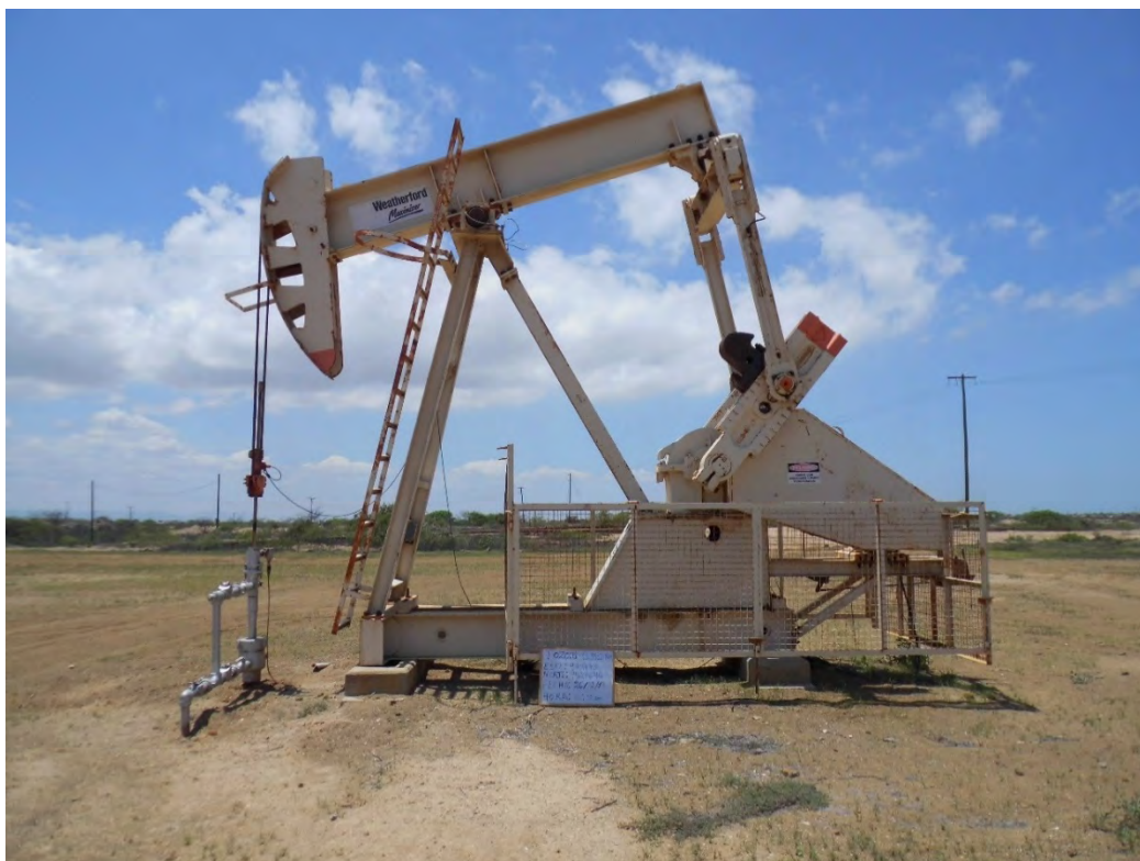
Fotografía 1. Pozo EA11351D (Coordenadas WGS84-zona 17S: 479773mE, 9527546mN), pozo productor tipo BM. Vista desde cerca del pozo. Sin indicio de derrame de hidrocarburos y alteración de suelo.
