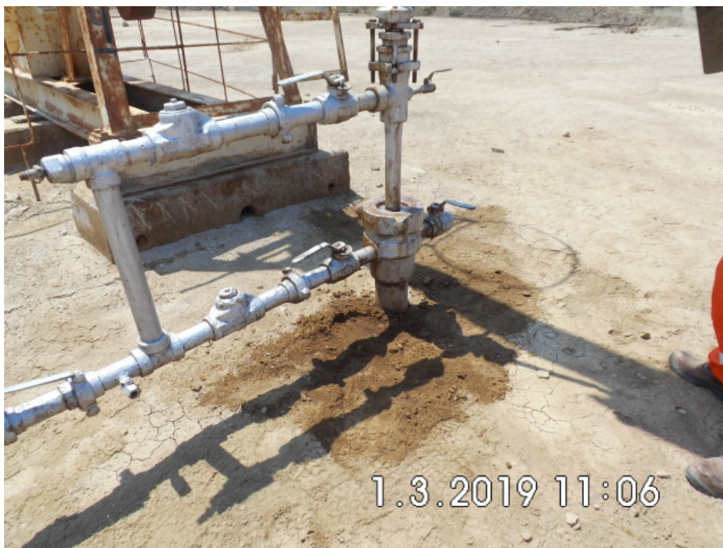
Fotografía 1. Pozo EA8119 (Coordenadas WGS84-zona 17S: 472192mE, 9527146mN), pozo productor tipo BM. Vista desde cerca del pozo. Con indicio de derrame de hidrocarburos y alteración de suelo alrededor del cabezal de pozo con un área de aproximadamente 2 m 2 .
