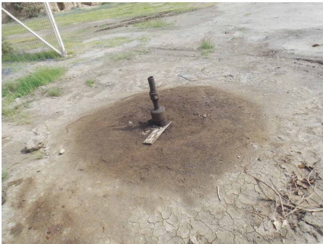
Fotografía 1. Pozo EA8583 (Coordenadas WGS84-zona 17S: 477550mE, 9529398mN), pozo productor tipo ACTPETF. Vista desde cerca del pozo. Con indicio de derrame de hidrocarburos y alteración de suelo alrededor del cabezal de pozo con un área de aproximadamente 2 m 2 .
