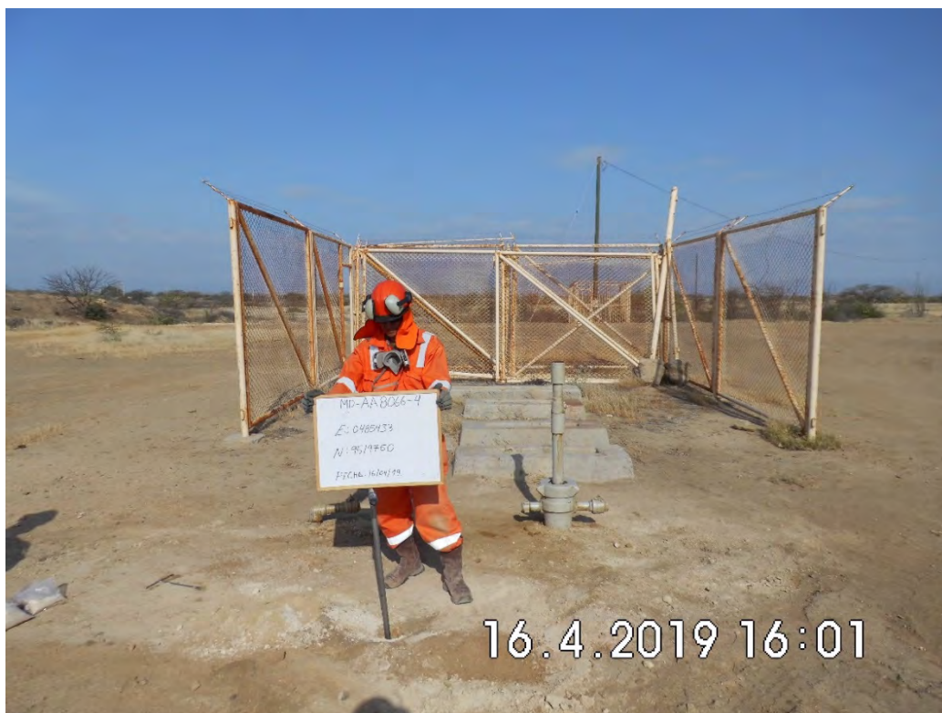
Fotografía 6. Pozo AA8066. Muestreo de Detalle (MD-AA8066-4). Se muestreo con intervalo de profundidad de 25 cm. La profundidad máxima alcanzada fue de 0.75 metros.
