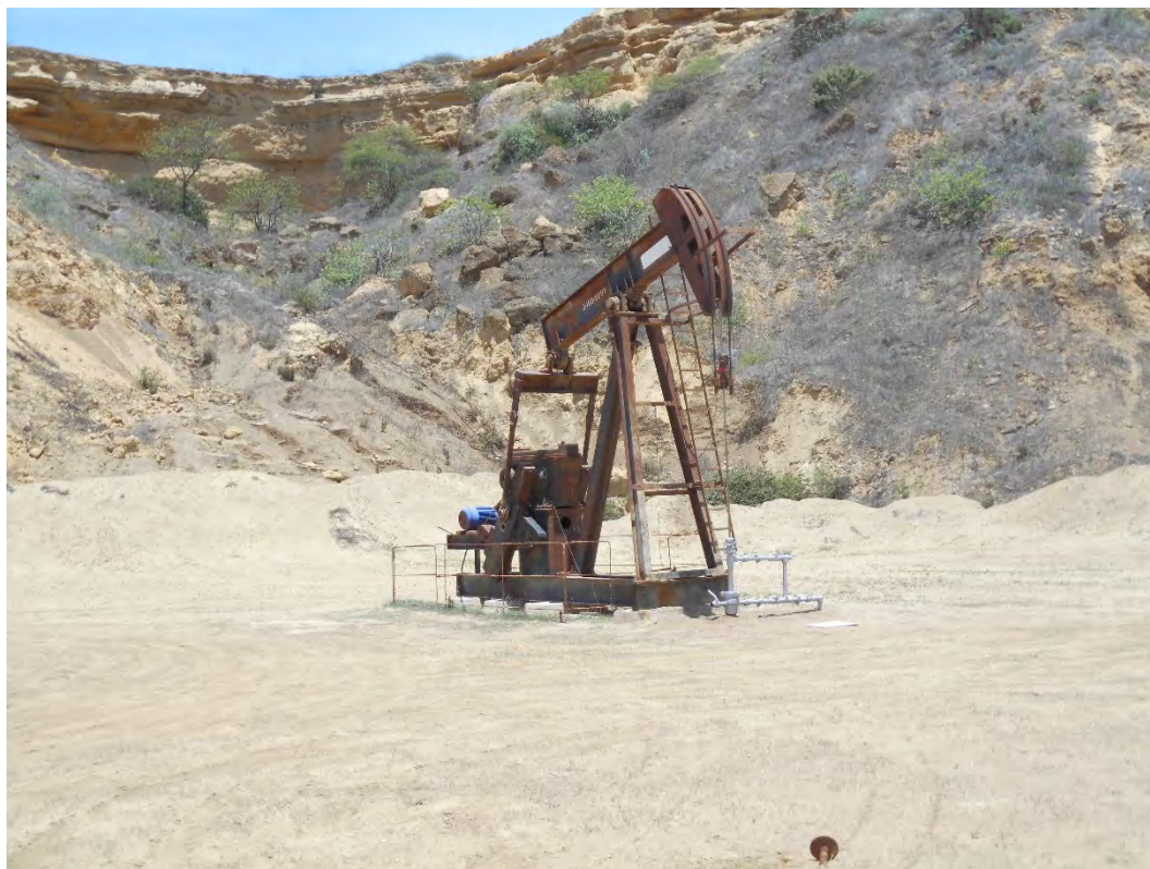
Fotografía 1. Pozo EA11002 (Coordenadas WGS84-zona 17S: 474855mE, 9527253mN), pozo productivo tipo BM. Vista desde cerca del pozo. Sin indicio de derrame de hidrocarburos ni alteración de suelo.
